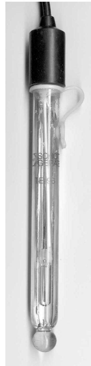
In prima approssimazione,  $V_g$ , il potenziale dell'elettrodo a vetro (il pedice g deriva dall'inglese *glass*), dipende dalla composizione della membrana stessa (silice contenente percentuali diverse di ossidi di metalli alcalini e alcalino-terrosi) e dal suo stato di idratazione superficiale, oltre che, naturalmente, dall'attività degli ioni idrogeno nella soluzione interna (nota e costante) e nella soluzione incognita,  $a_{H^+}$ .
