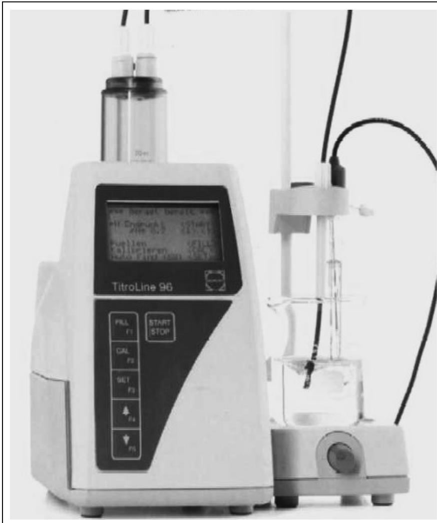
Un titolatore automatico altro non è che una pompa, capace di erogare volumi controllati di liquido (titolante), accoppiata con un voltmetro elettronico che permette di misurare il potenziale di un elettrodo indicatore dopo ogni aggiunta automatica di titolante.
