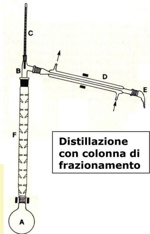
**Distillazione con colonna di frazionamento**
