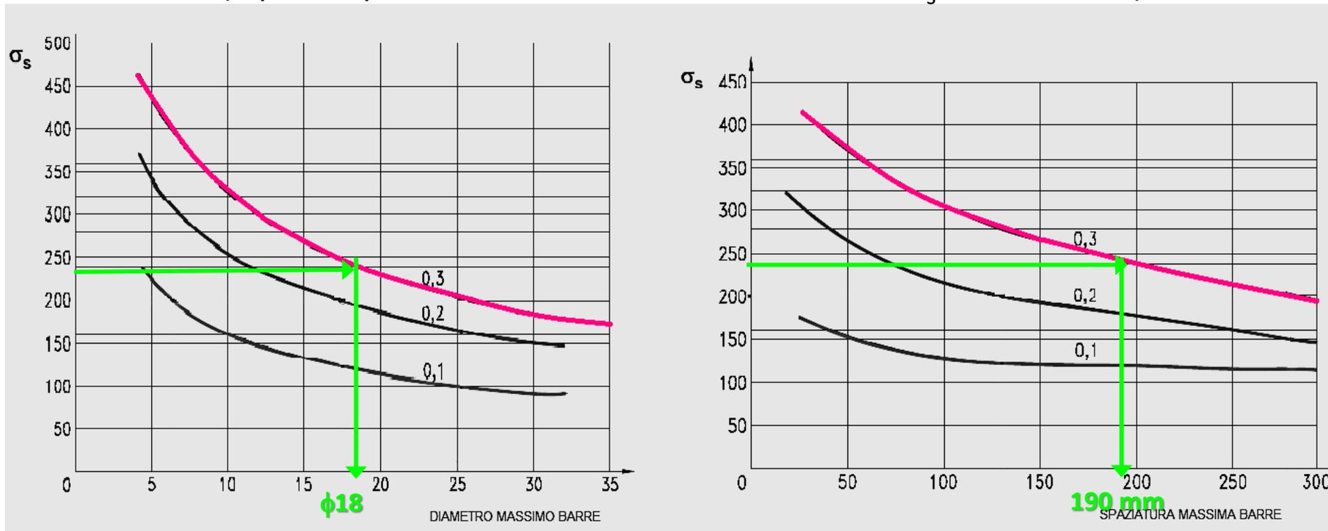
$\phi 14 \leq \phi 18$  e  $60 \text{ mm} < 190 \text{ mm}$  ✓ VERIFICATO
