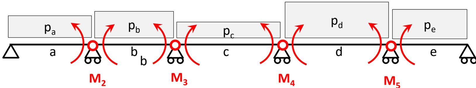
La risoluzione con il metodo delle forze è laboriosa. Si consideri allora la generica campata «j»: le rotazioni agli estremi possono essere ottenute mediante SOVRAPPOSIZIONE DEGLI EFFETTI, considerando separatamente 3 condizioni di carico:
