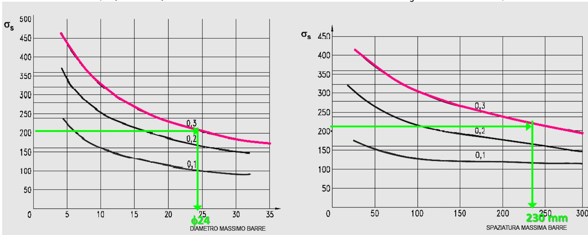
$\phi 14 < \phi 24$  e  $60 \text{ mm} < 230 \text{ mm}$  ✓ VERIFICATO
