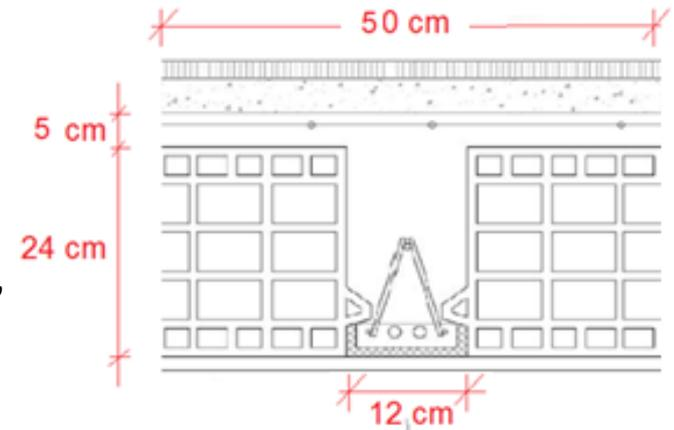
$$- \quad g_{k1} \quad 3,30 \text{ kN/m}^2 * 0,5\text{m} \quad = \quad 1,65 \text{ kN/m}$$
