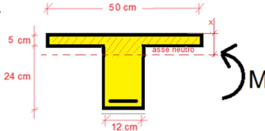
Tuttavia, siccome la differenza  $x-s$  ( $=10,81 \text{ mm}$ ) non è elevata rispetto all'altezza della sezione e che le tensioni  $\sigma_c$  e  $\sigma_s$  calcolate sono abbondantemente inferiori ai valori limite, le verifiche possono essere considerate soddisfatte senza procedere con calcoli più rigorosi.
