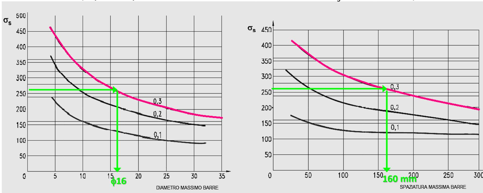
$\phi 14 < \phi 16$  e  $60 \text{ mm} < 160 \text{ mm}$  ✓ VERIFICATO
