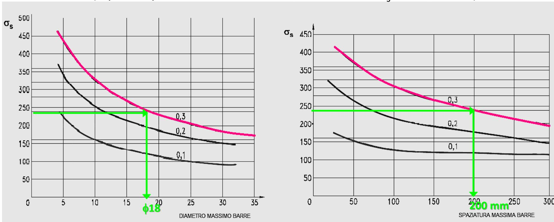
$\phi 14 < \phi 18$  e  $40 \text{ mm} < 200 \text{ mm}$  ✓ VERIFICATO
