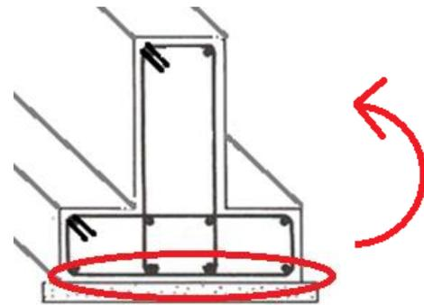
OSS. d sarà pari all'altezza della trave (1000mm) diminuita del copriferro netto (50 mm), del diametro delle staffe (8mm) del raggio delle armature (8 mm)
