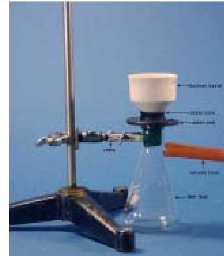
Filtrazione in depressione
