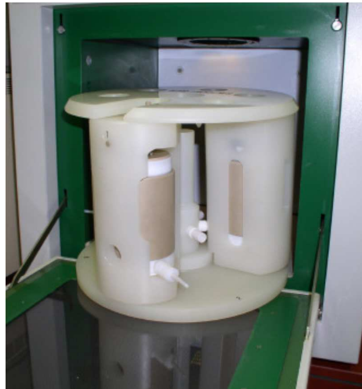
Assemblaggio di tre reattori per l'estrazione/filtrazione in un rotore alloggiato nel forno a microonde ETHOS 1600
