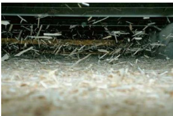
Distribuzione dei trucioli dello strato centrale
