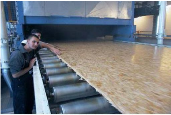
Pannello „ininterrotto“ sui rulli della pressa
