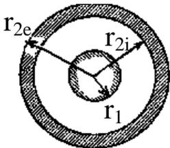
Chiamato  $d_i$  il diametro del conduttore interno
