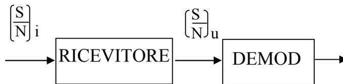
All'uscita della sezione RF del ricevitore (all'ingresso del demodulatore) il rapporto S/N è diverso in quanto al rumore di ingresso si è aggiunto il rumore degli stadi del ricevitore
