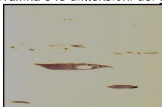
Stringler longitudinali di inclusioni (esame macroscopico).
