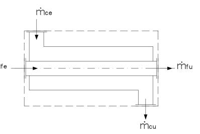
$$\begin{split} h &= c \big( T - T_0 \big) \rightarrow \dot{m}_c \cdot c \cdot t_{ce} + \dot{m}_f \cdot c \cdot t_{fe} = \dot{m}_c \cdot c \cdot t_{cu} + \dot{m}_f \cdot c \cdot t_{fu} \\ \dot{m}_c T_{cu} + \dot{m}_f T_{fu} &= \dot{m}_f T_{fe} + \dot{m}_c T_{ce} \\ \dot{m}_f &= \dot{m}_c \frac{T_{ce} - T_{cu}}{T_{fu} - T_{fe}} = 200 \frac{kg}{s} \end{split}$$
