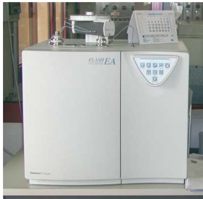
Analizzatore elementare per la determinazione dell'azoto
