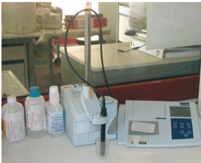
Strumento per la determinazione della conducibilità elettrica
