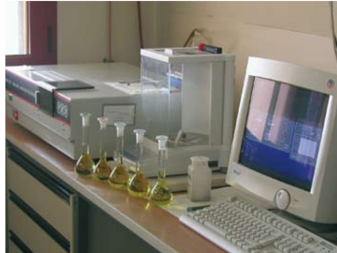
Analizzatore elementare per la determinazione del mercurio
