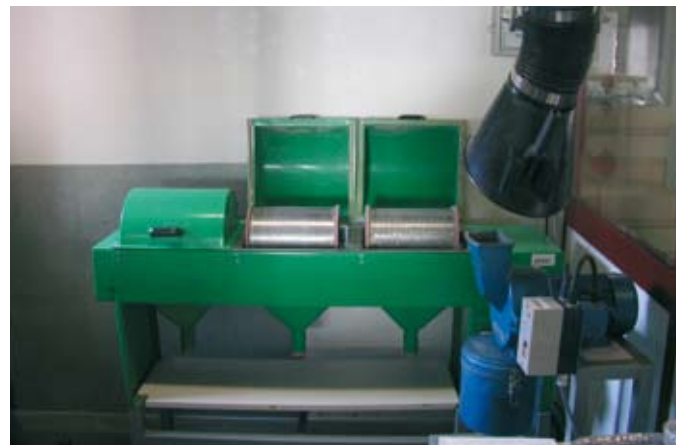
Prima dell'analisi i terreni vengono setacciati per ottenere un campione con particelle di diametro inferiore a 2 mm
