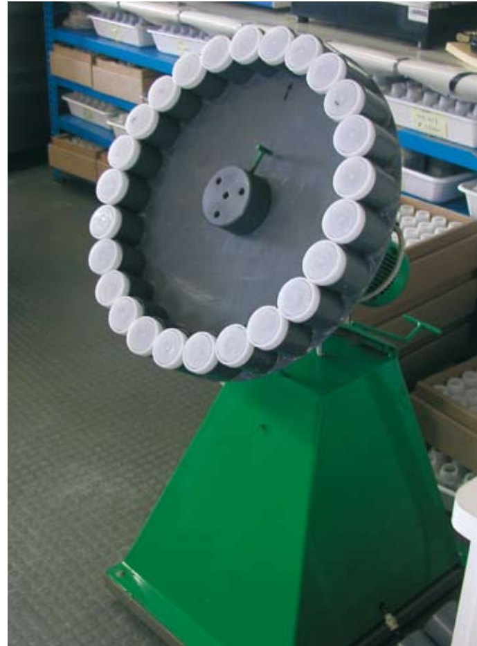
Agitatore rotativo utilizzato per l'estrazione dei microelementi assimilabili
