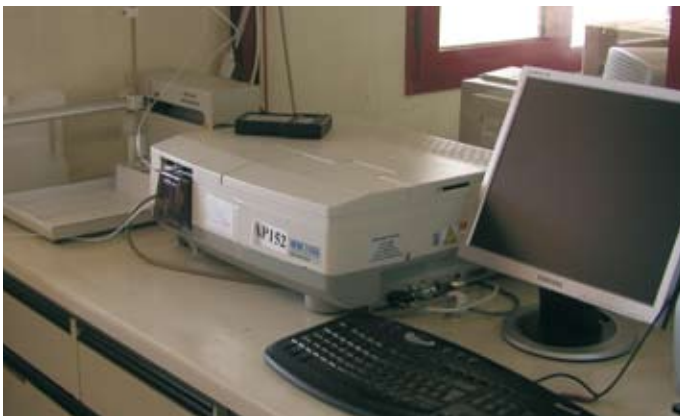
Spettrofotometro per l'analisi colorimetrica del fosforo assimilabile
