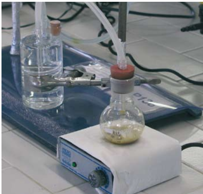
Calcimetro per la determinazione del calcare totale
