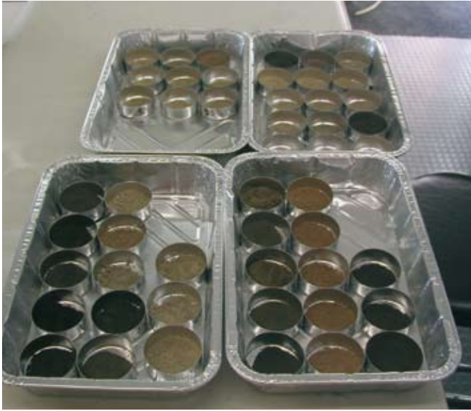
Aliquote prelevate con il metodo della pipetta prima dell'essiccazione in stufa
