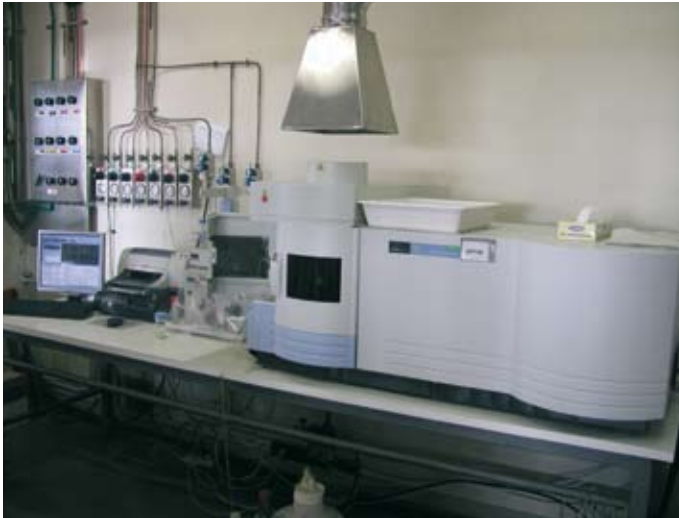
ICP ottico utilizzato per la determinazione dei metalli
