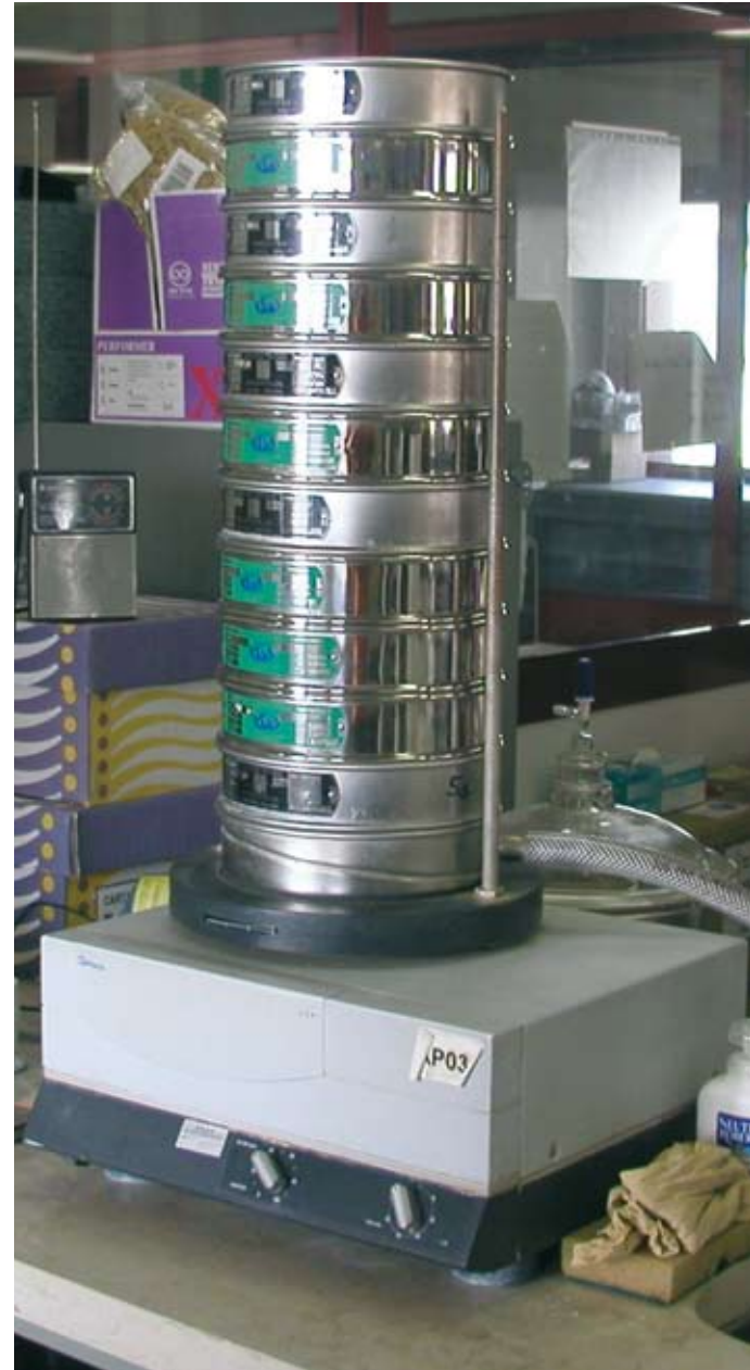
Pila di setacci per il frazionamento delle sabbie
