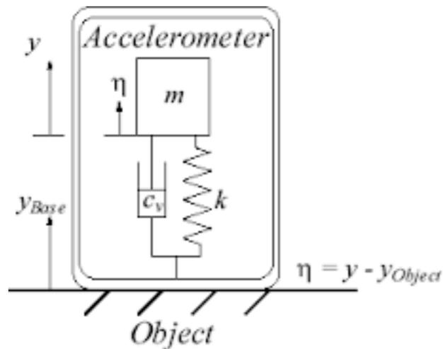
Dal moto relativo tra massa sismica e oggetto (comprimendo e allungando la parte elastica) si genera il segnale elettrico di interesse..
