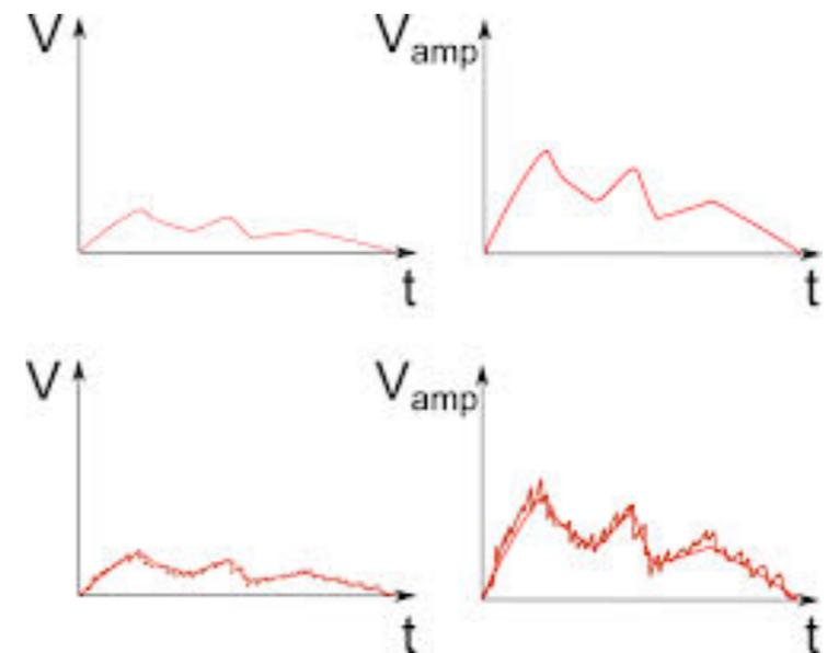
Esistono amplificatori IEPE combinano l'alimentazione del sensore all'amplificazione del segnale, all'integrazione del segnale (accelerazione > velocità > spostamento), al filtraggio del segnale (passaalto o/e passabasso)
