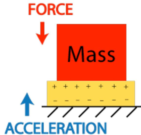
Al concetto generale di massa sismica/elemento piezo, si possono accostare diverse tipologie di costruzione per migliorare la risposta del sensore, renderlo più insensibile ai disturbi esterni, elevare la frequenza di risonanza...
