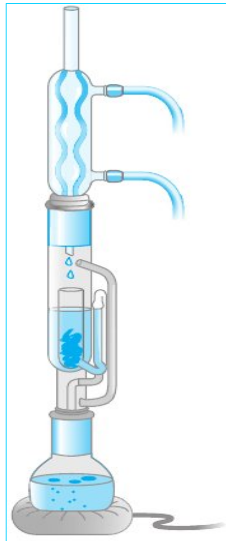
Figura 1.2 Estrattore di Soxhlet.
