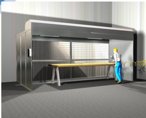
Figura 28 Cabina di verniciatura a chiusura parziale (a sinistra) e a chiusura totale (a destra)
