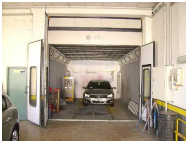
Figura 28 Cabina di verniciatura a chiusura parziale (a sinistra) e a chiusura totale (a destra)
