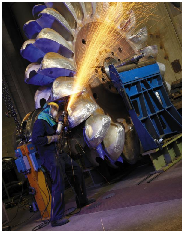
Figura 10 Particolato metallico emesso ad elevata velocità durante un'operazione di smerigliatura
