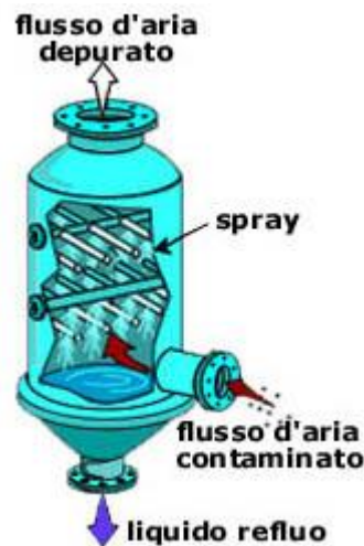
Figura 64 Schema di torre spray
