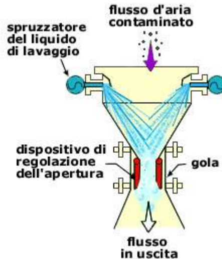
Figura 71 Depuratore Venturi – Principio di funzionamento
