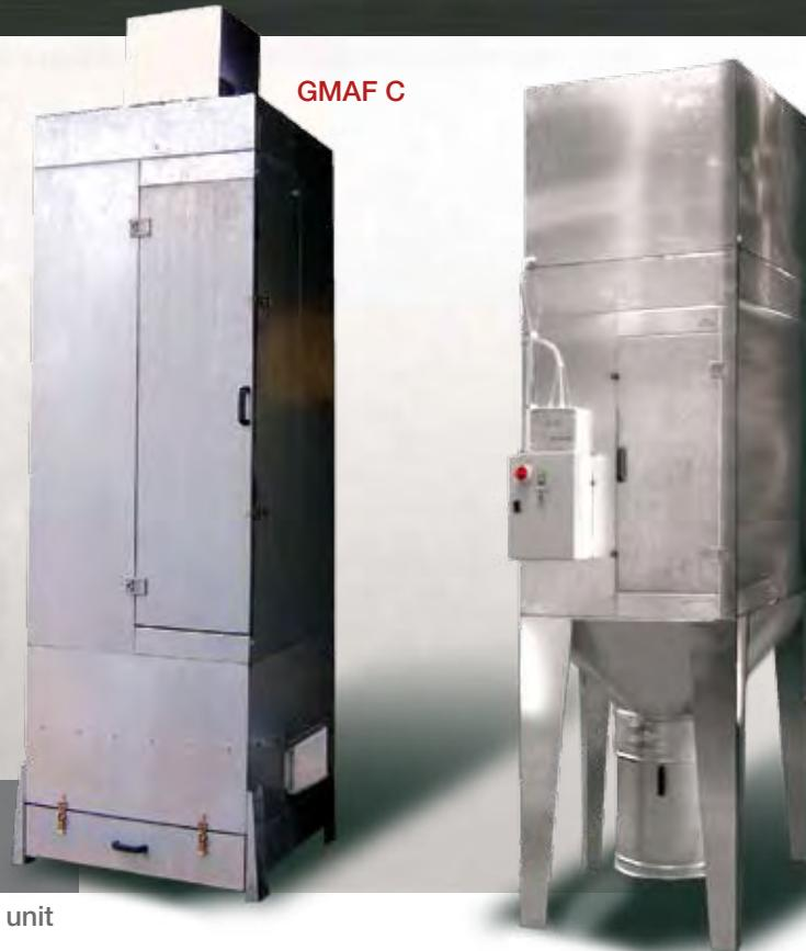
I gruppi filtranti **GMAF** sono filtri a maniche realizzati con pannelli modulari costruiti in robusta lamiera zincata pressopiegata. Questi filtri sono caratterizzati da una notevole capacità di filtraggio e dalla possibilità, in caso di necessità, di poterli ampliare facilmente per esigenze più gravose.
