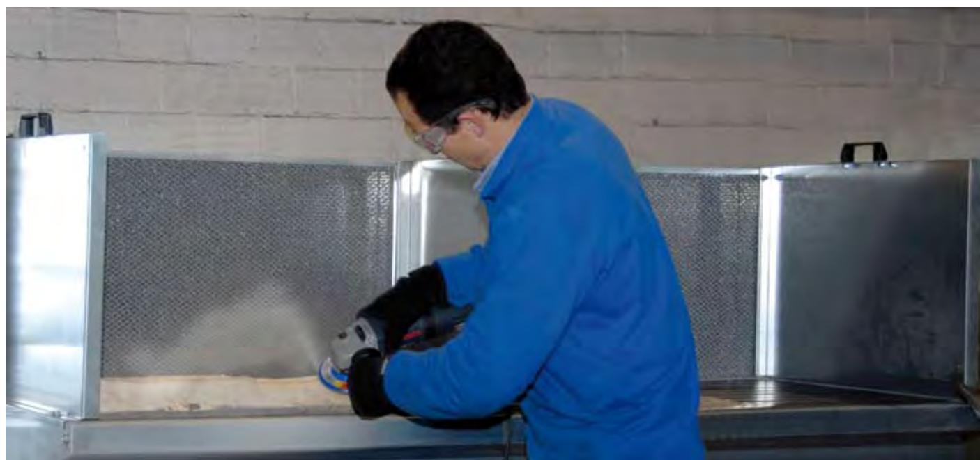
Die Absaugende Werkbank **BAG** ist eine kombinierbare Werkbank, je nach verschiedenen Bedürfnissen und je nach Industriezweig die abzusaugenden Rückstände von Farben, Lösemittel, Rauch und Schleifstaub. Die Werkbänke gibt es in den Ausführungen **10, 20 und 30**, entsprechend der Breite der Arbeitsplatte 900 mm, 1900 mm und 2800 mm.
