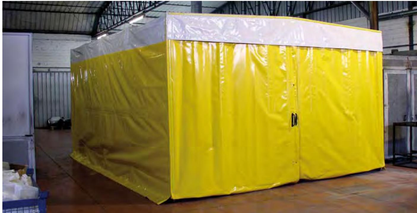
Wenn es nicht möglich ist schädliche Substanzen in einem bestimmten Punkt direkt zu erfassen, ist es vorzuziehen Produkte zu benützen die einen ausgedehnten Bereich definitiv absaugen.
