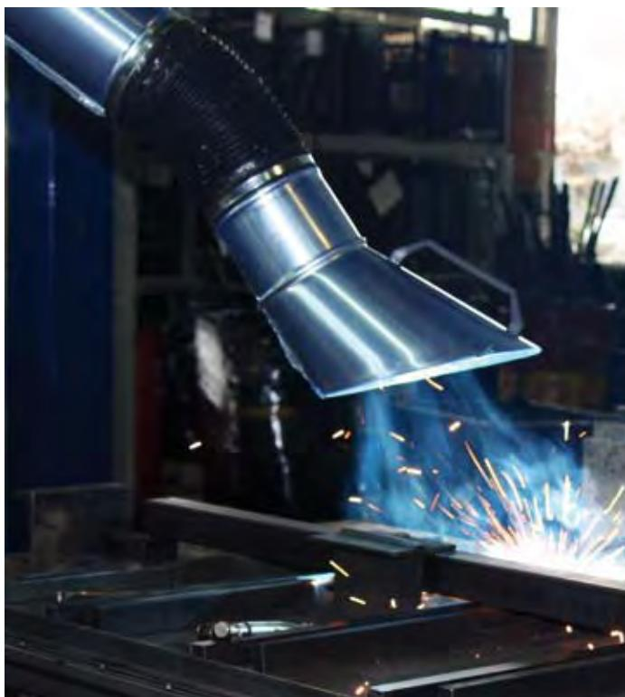
Die Absaugarme sind eine nützliche Arbeitsbegleitung adressiert an die Absaugung der schädlichen Substanzen in inneren, lokalisierten Zonen der Industrieabteilungen.
