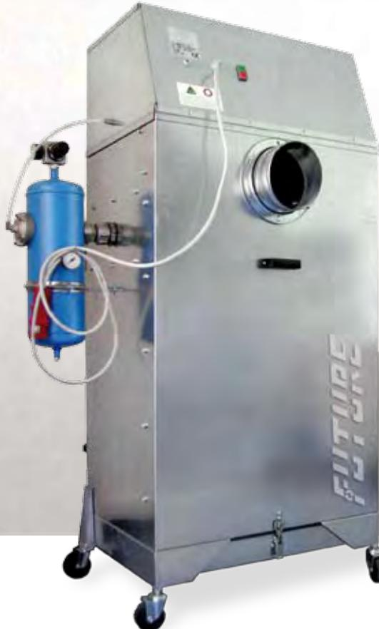
**MISTER FIST** è un gruppo filtrante carrellato adatto per aspirazione e la filtrazione delle polveri (anche molto sottili). La struttura del filtro carrellato è realizzata in robusta lamiera zincata presso piegata. Su di essa, nella parte posteriore, è posizionato un raccordo per il collegamento della tubazione aspirante (diametro a scelta in base all'esigenza delle lavorazioni da 80 a 200 mm), del braccio o di combinazioni tra braccio e tubazione flessibile.
