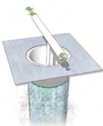
**La pulizia pneumatica dei filtri avviene grazie ad un sistema di ugelli che soffiano dall'interno dei cilindri filtranti aria compressa, staccando così le scorie dal filtro e facendole cadere nella zona di raccolta. Il sistema è gestito da un generatore ciclico che, ad intervalli regolari, rilascia attraverso gli ugelli l'aria compressa contenuta in un serbatoio di supporto.**
