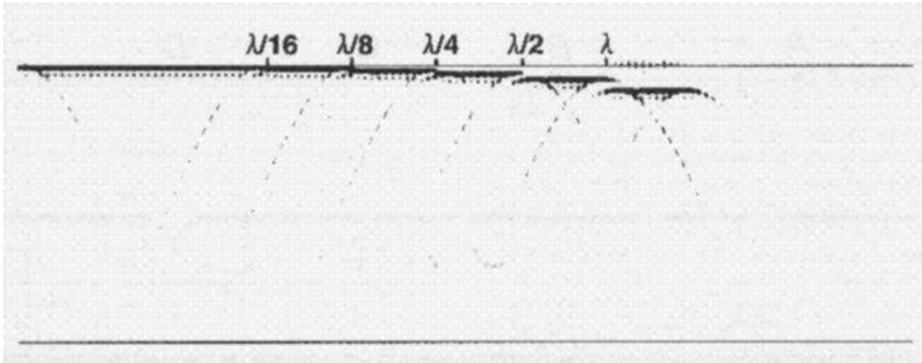
Il rigetto verticale è “riconoscibile” quando raggiunge e supera il valore di  $\frac{1}{4}$  della lunghezza d’onda (risoluzione verticale).
