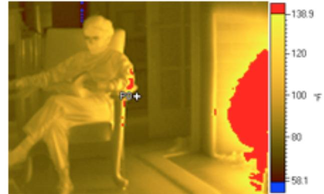
Nel trasporto per irraggiamento il calore viene veicolato attraverso radiazione elettromagnetica (nello spettro infrarosso). Questa radiazione interagisce con i legami covalenti delle molecole, eccitandone la vibrazione e causandone così il “riscaldamento”.
