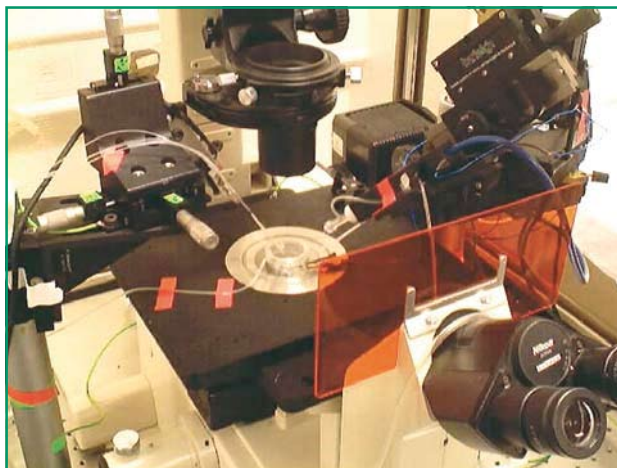
Apparecchiatura usata per monitorare i deboli voltaggi elettrici rilevabili nelle sinapsi.
