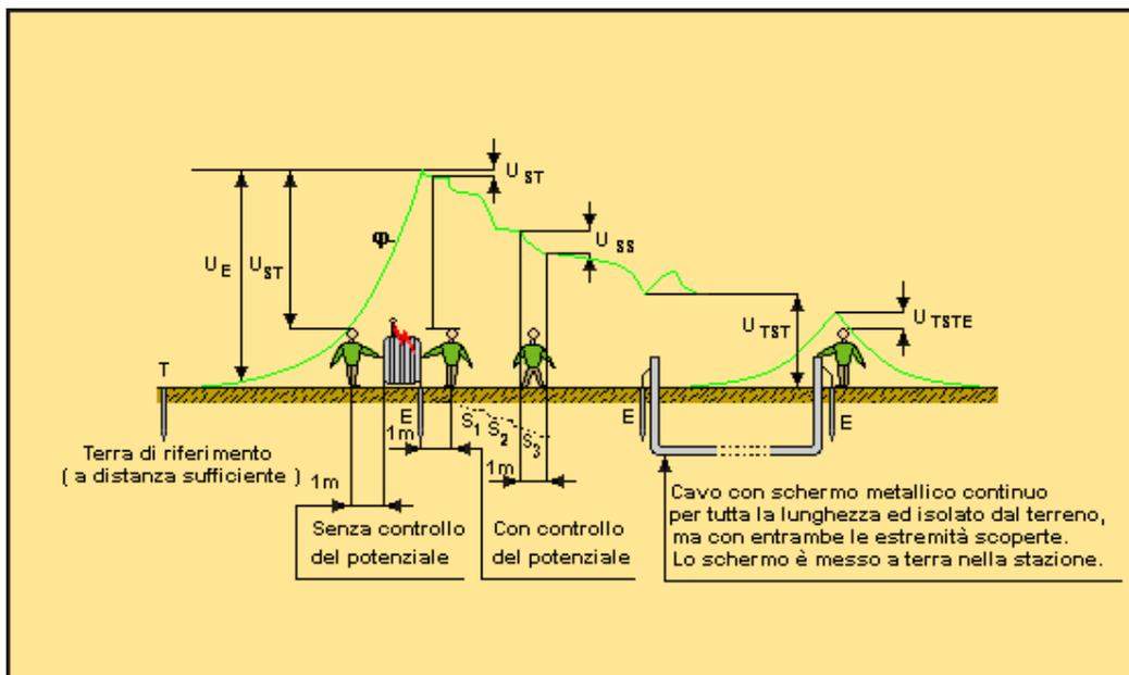
Fig. 1 – Definizioni relative alle tensioni negli impianti
