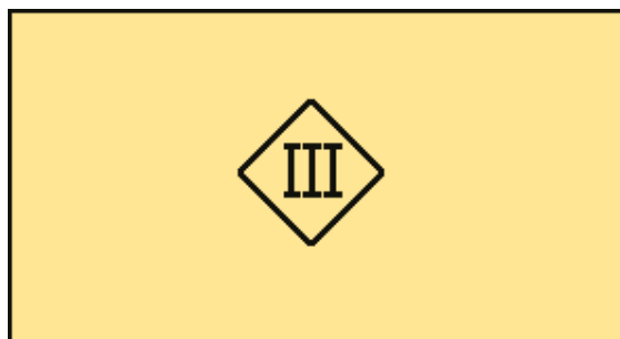
Fig. 8.8 - Simbolo grafico di un apparecchio di classe III.
