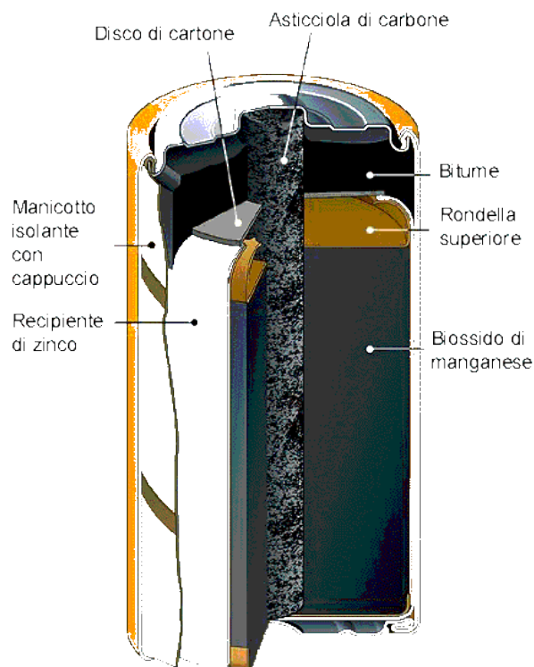
Struttura di una tipica pila zinco - carbone (Sorgente: Varta)
