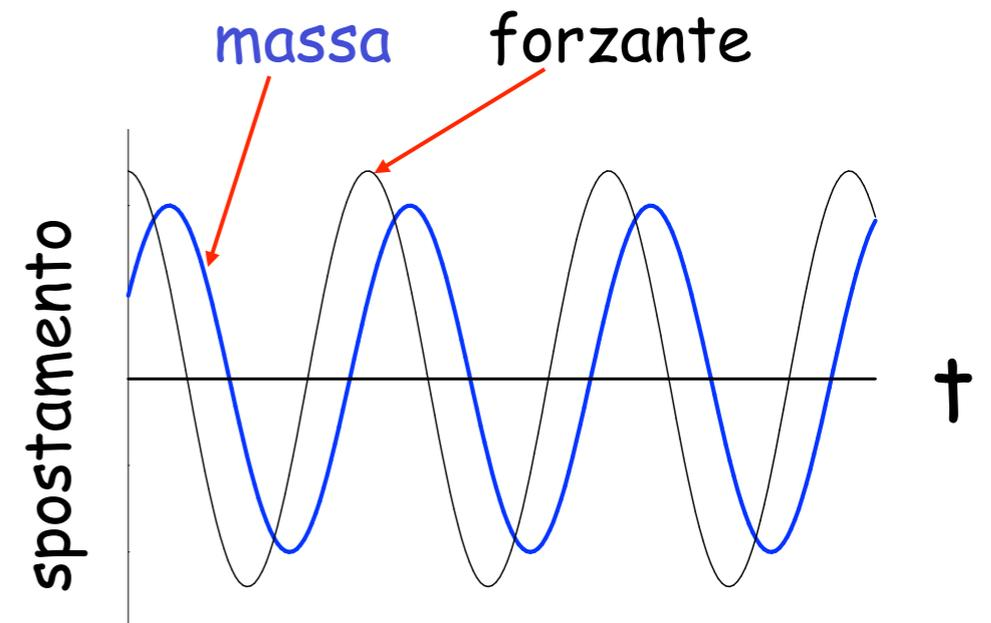
$\therefore$  lo spostamento  $x = x_0 \cos(\omega t - \phi)$  dove  $\phi = \omega \Delta t = \frac{2\pi \Delta t}{T}$
