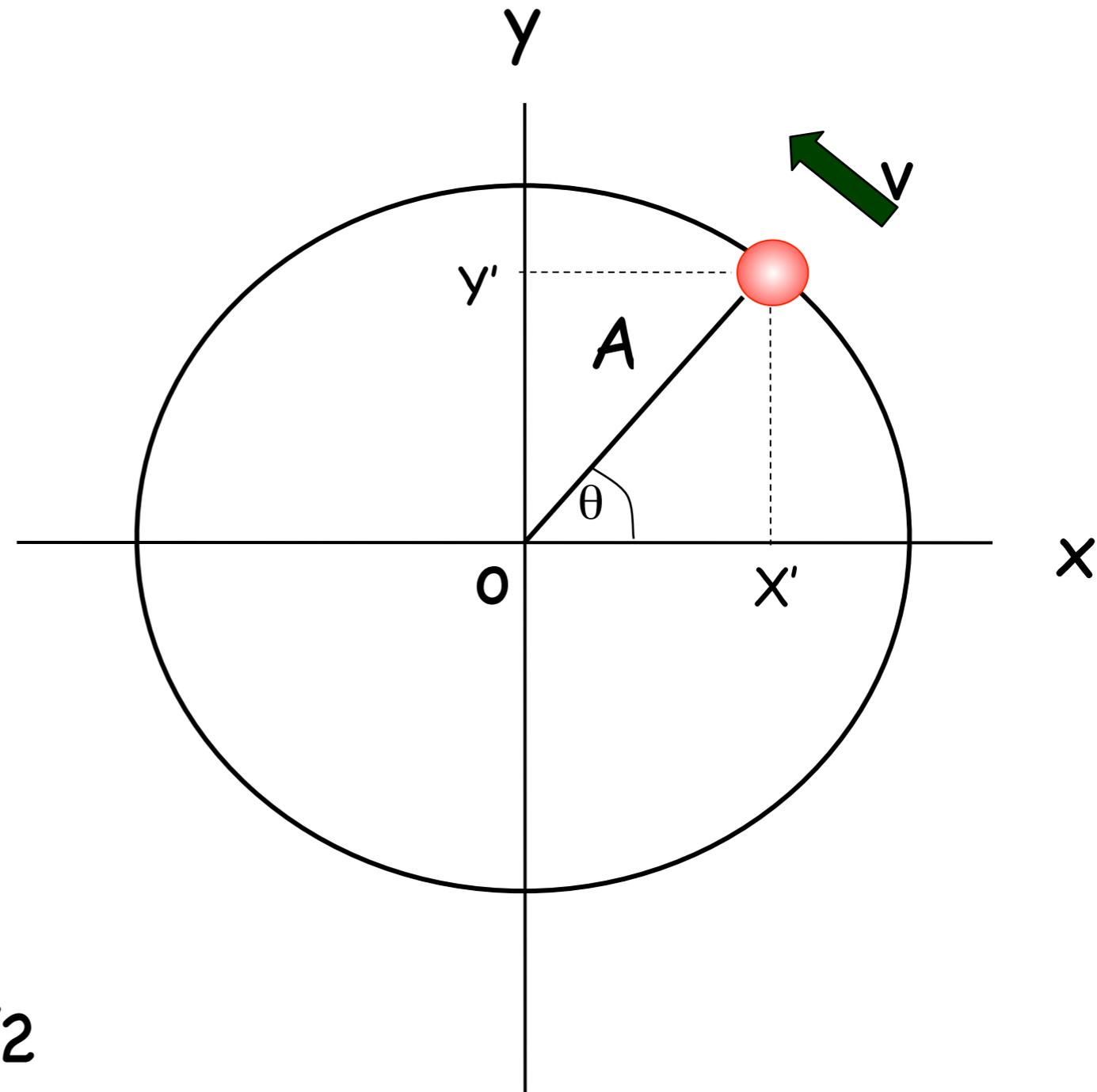
Quando una particella si muove con velocità costante su di un cerchio la sua proiezione sul diametro si muove con SHM.
