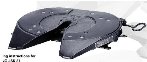
L'aggancio avviene automaticamente spingendo la motrice contro il perno del rimorchio. A causa del contatto, la ganascia ruota e manualmente è sufficiente azionare il chiavistello di serraggio agendo sulla leva di comando manuale.
