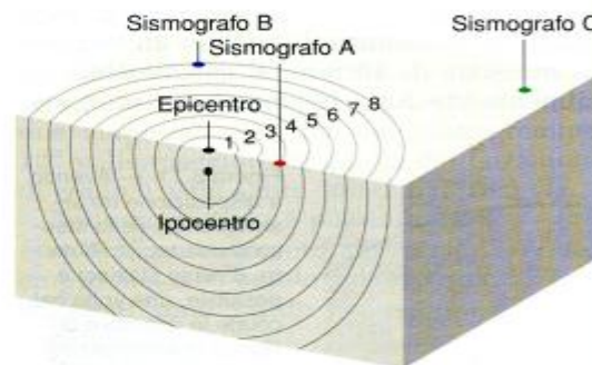
Figura 8.9. I numeri riportati sui fronti d'onda esprimono il ritardo in minuti tra l'arrivo delle onde P e delle onde S in tre diverse stazioni sismiche. Poiché le onde P viaggiano a velocità quasi doppia delle onde S, più una stazione è lontana più il ritardo delle onde S sulle P aumenta.
