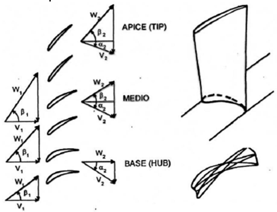
Figura 5.28: Profili e triangoli delle velocità per un rotore di turbo.fan a vortice libero  $(r_{Tip}/r_{Hub}=2)$ .
