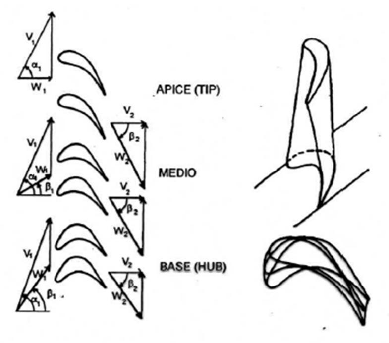
Figura 5.27: Profili e triangoli delle velocità per il rotore di uno stadio di bassa pressione di turbina a vapore o a gas  $(r_{Tip}/r_{Hub} = 1.4)$ .
