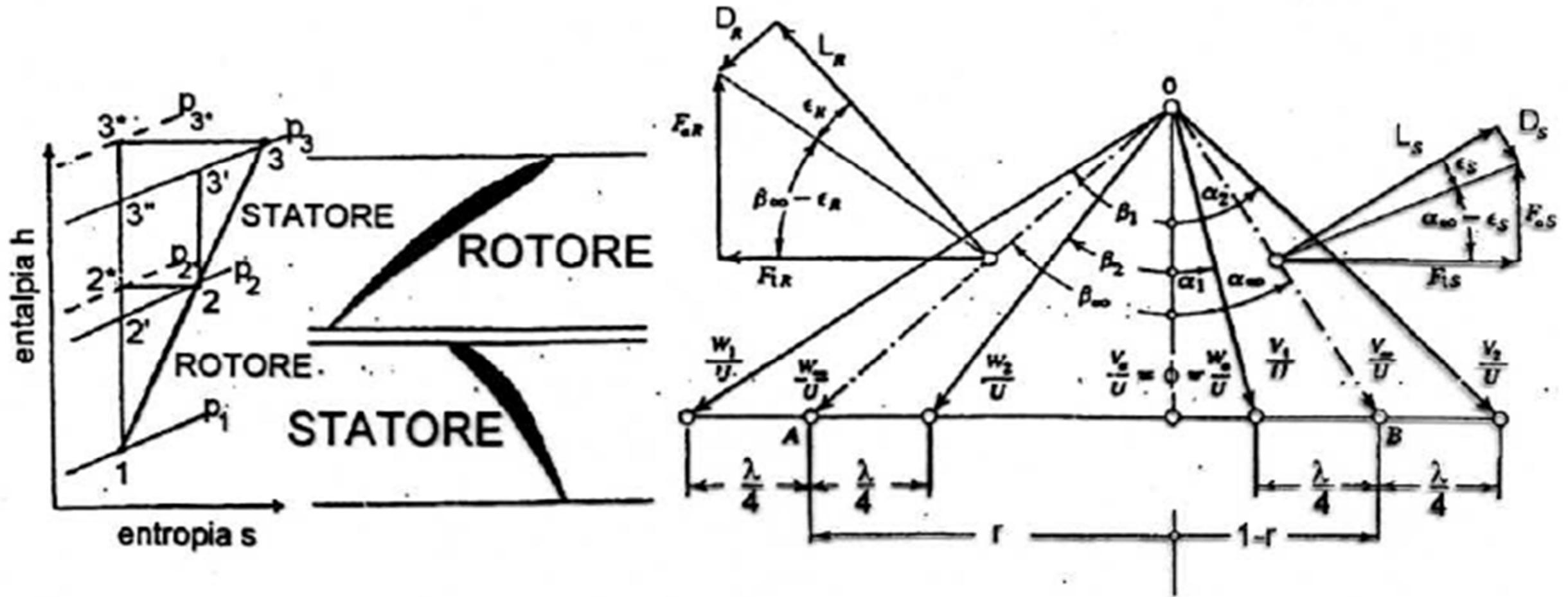
Figura 6.3: *Stadio ripetuto di compressore assiale. Triangoli delle velocità adimensionali e trasformazione termodinamica.*
