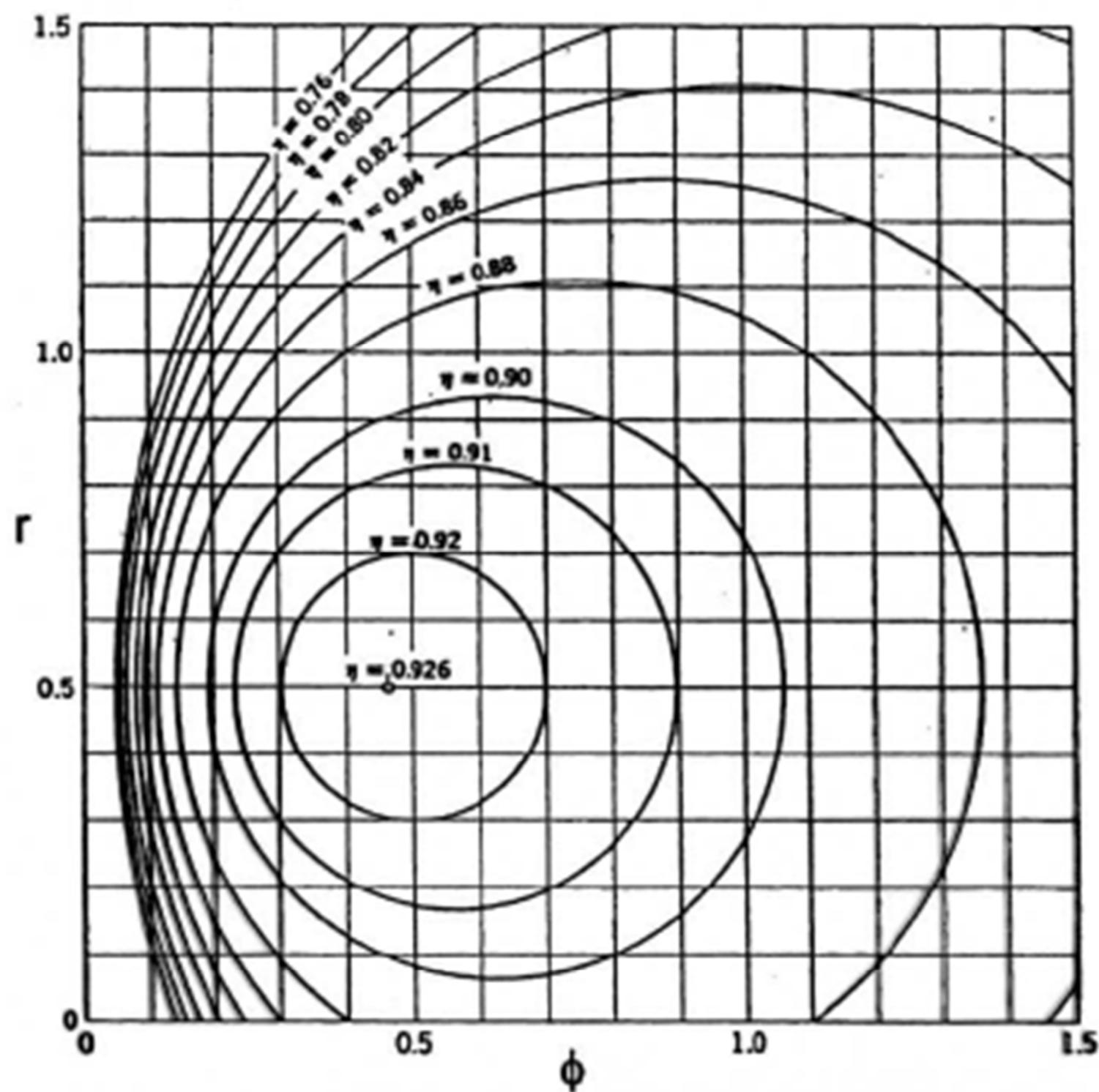
Figura 6.4: Curve iso-rendimento di uno stadio di compressore assiale in funzione del coefficiente di portata e del grado di reazione (finezza  $\epsilon$  dei profili = 0.04).
