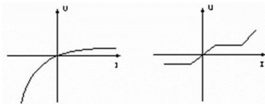
La figura a sinistra indica la caratteristica di un diodo, quella a destra indica la caratteristica di un bipolo lineare a tratti.
