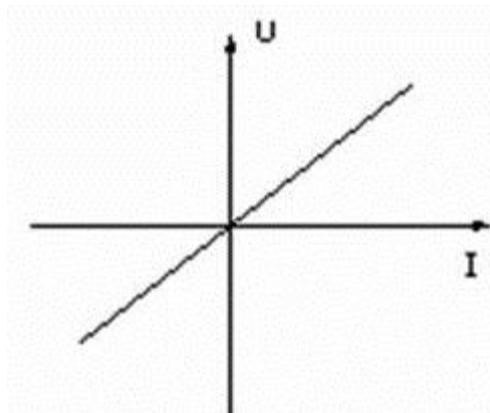
Caratteristica di una resistenza: esempio di bipolo inerte e passivo.
