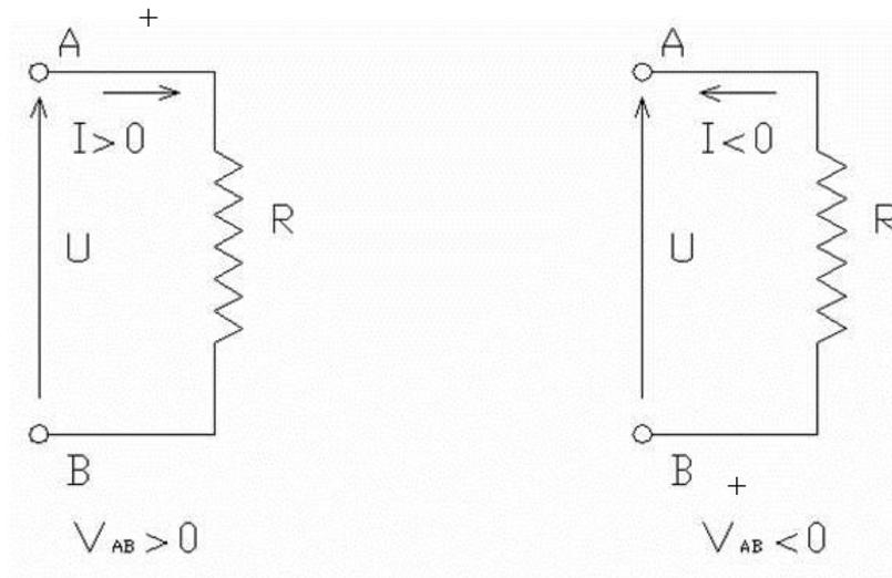
$$U_{AB} = V_A - V_B \text{ con } V_A - V_B > 0 \text{ e } V_A > V_B$$
