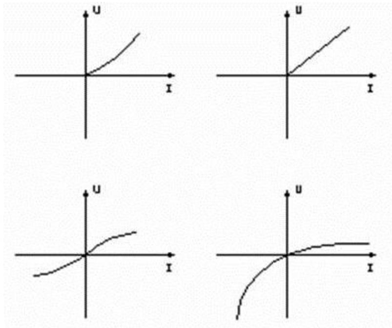
Esempi di caratteristiche di bipoli inerti
