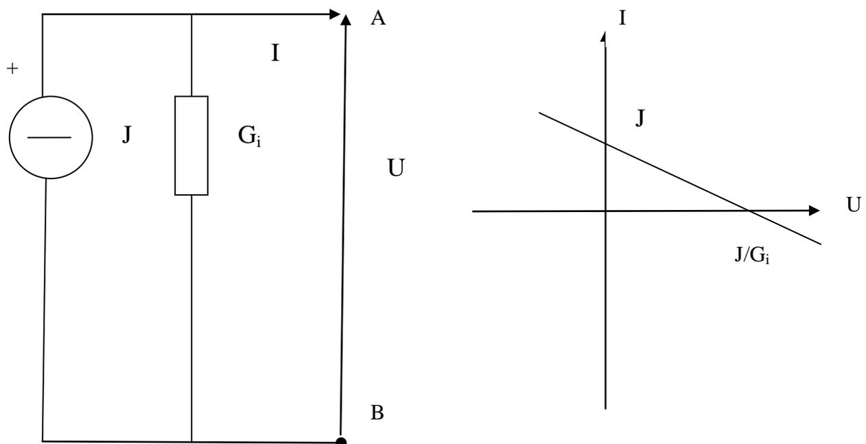
Modello circuitale e caratteristica di un generatore di corrente reale
