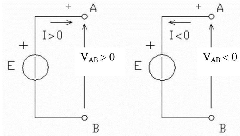
$$U_{AB} = V_A - V_B \quad \text{con} \quad V_A - V_B > 0 \quad \text{e} \quad V_A > V_B$$
