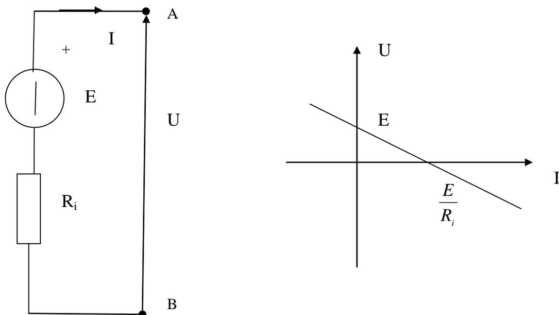
Modello circuitale e caratteristica di un generatore di tensione reale
