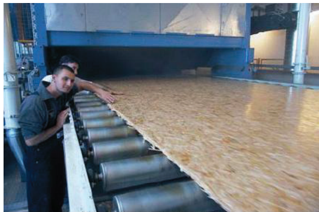
Pannello „ininterrotto“ sui rulli della pressa
