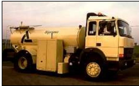
**CNR B.U. n.147/92 - Metodo di prova per la misura del coefficiente di aderenza con l'apparecchio S.C.R.I.M.**
