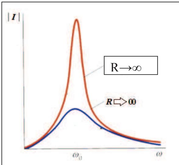
Per la risonanza parallelo all'aumentare di  $R$  si aumenta l'effetto della attenuazione del filtro attenua banda parallelo, infatti  $I_{min} = \frac{U}{R_i} = G_i U$ , quindi all'aumentare di  $R$ , diminuisce  $I_{min}$ .
