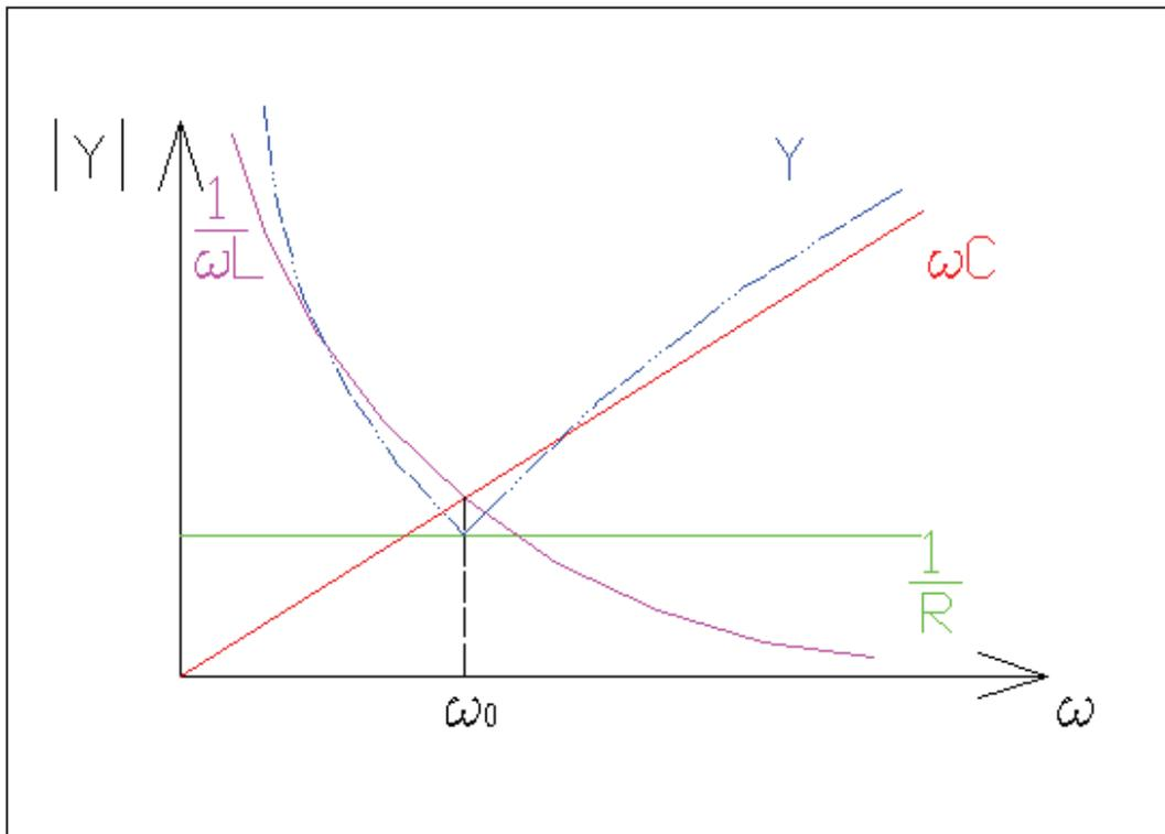
La corrente  $\bar{I} = \dot{Y} \bar{E}$  risulterà minima per la pulsazione  $\omega = \omega_0$ .
