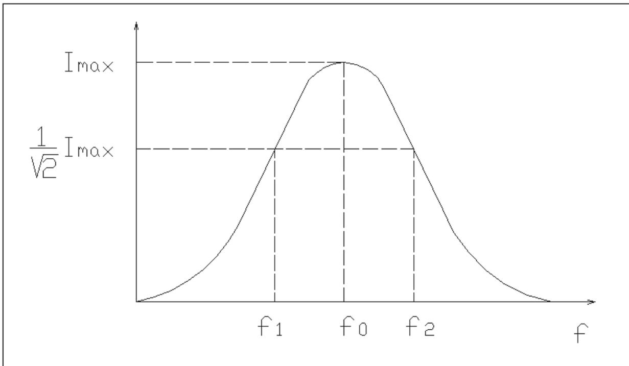
In tale filtro passa banda reale  $f_1$  ed  $f_2$  sono i valori delle due frequenze di taglio di un filtro passa banda reale e rappresentano quei valori di frequenza per le quali il segnale di uscita si riduce a circa il 70% del segnale di corrente in ingresso, con una attenuazione di 3 dB.
