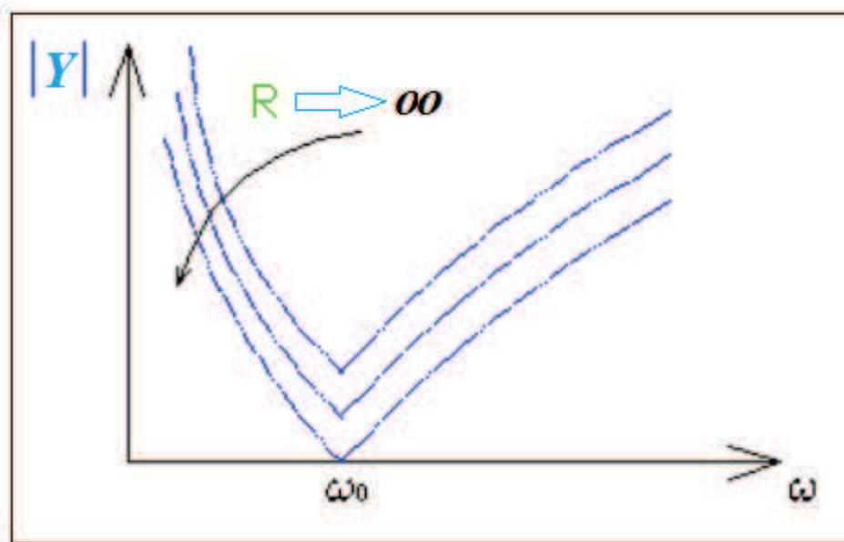
Inoltre, se  $R \rightarrow \infty$ , la tensione  $\bar{U}_{AB}$ , in condizioni di risonanza per  $\omega = \omega_0$ , sarà infinita, mentre per  $R \rightarrow 0$  sarà nulla (cortocircuito).
