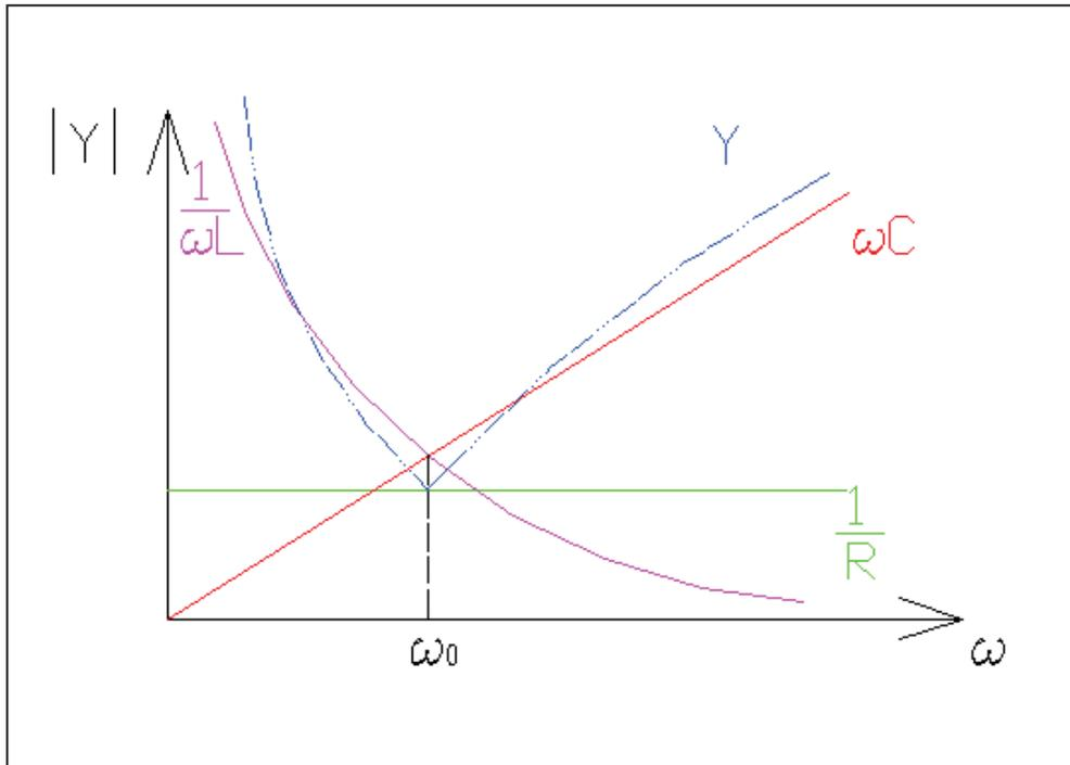
La tensione  $\bar{U}_{AB} = \bar{I} / \dot{Y}$  per  $|\bar{I}| = \text{costante}$ , varierà al variare della frequenza e sarà massima per la pulsazione  $\omega = \omega_0$
