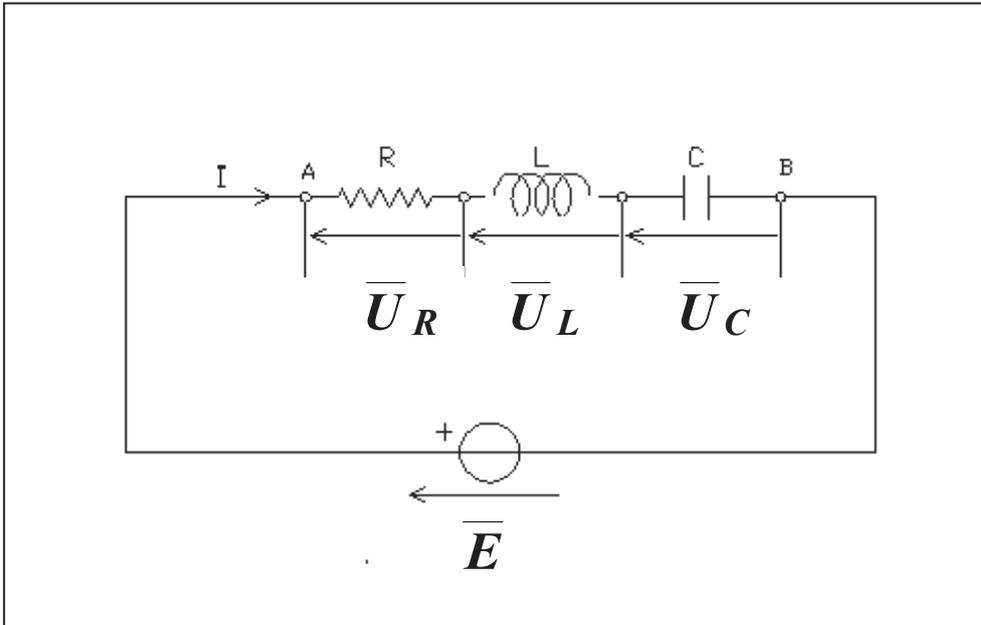
Si supponga di far variare la frequenza  $f$  da zero ad infinito. Poiché le reattanze variano al variare della frequenza, avremo un circuito che potrà avere sia un comportamento elettrico prevalentemente induttivo, che capacitivo secondo il valore della frequenza imposta dal generatore di tensione:
