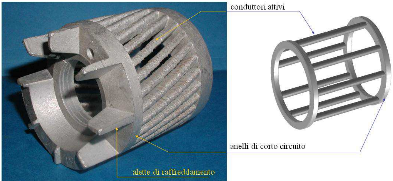
Rotore a gabbia in alluminio pressofuso
