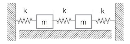
$$\begin{bmatrix} m_{11} & m_{12} \\ m_{21} & m_{22} \end{bmatrix} \begin{bmatrix} \ddot{x}_1 \\ \ddot{x}_2 \end{bmatrix} + \begin{bmatrix} k_{11} & k_{12} \\ k_{21} & k_{22} \end{bmatrix} \begin{bmatrix} x_1 \\ x_2 \end{bmatrix} = \begin{bmatrix} p_1 \\ p_2 \end{bmatrix}$$
