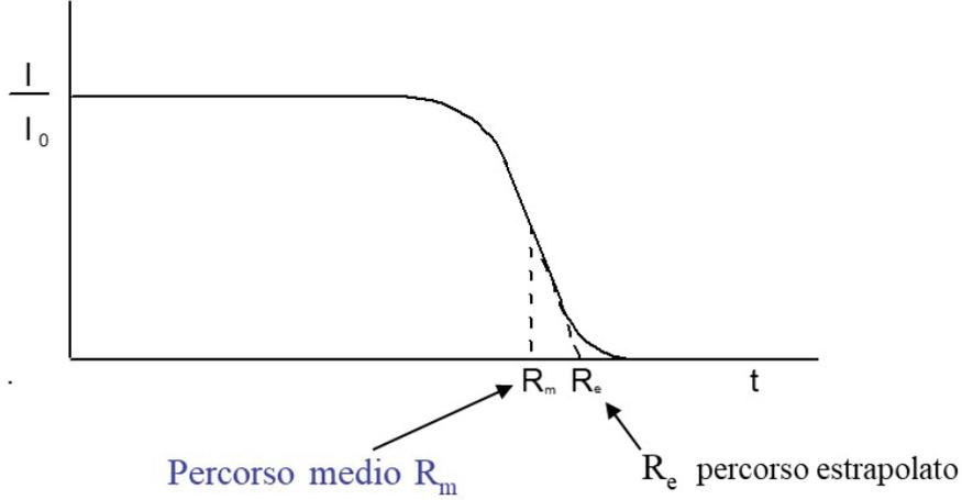
Figure 13: Determinazione del range a partire da una curva di trasmissione ( $I$  è il numero di particelle trasmesse per unità di tempo in funzione delle spessore  $t$  essendo  $I_0$  il numero di particelle entranti) di un fascio di particelle in funzione dello spessore  $x$  attraversato ( $R_m$  è il range medio,  $R_e$  è il range estrapolato).
