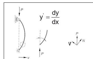
Esprimendo l'azione flettente con riferimento alla configurazione deformata dell'asta:
