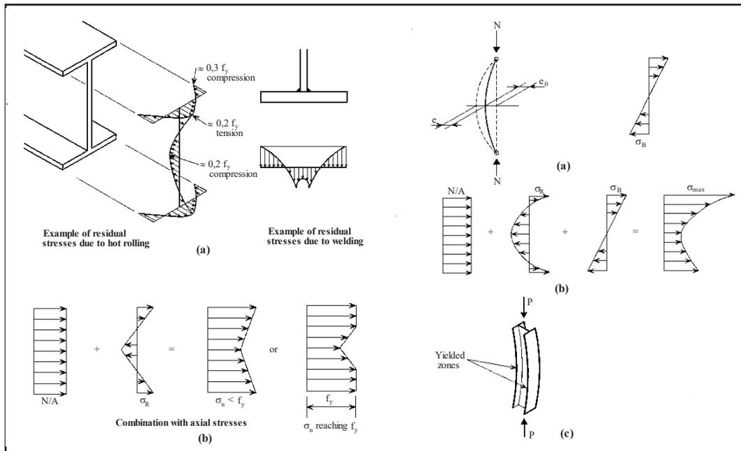
A seguito delle imperfezioni geometriche iniziali, che si possono schematizzare con un'eccentricità iniziale del carico di compressione, l'asta risulta pressoinflessa.
