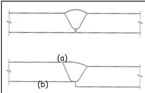
La manca di penetrazione (a) si manifesta quando esistono zone in cui il materiale fuso non è penetrato e la saldatura dell'unione non risulta pertanto continua. Il disassamento dei lembi è dovuto invece ad un montaggio imperfetto delle componenti da unire che può provocare una variazione della geometria del profilo assemblato.
