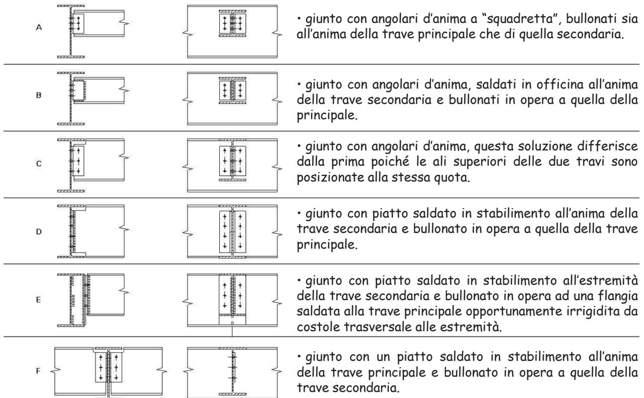
**Giunti a squadretta:** una volta determinata la posizione delle reazioni della trave secondaria (secondo lo schema pendolare), il calcolo dei collegamenti deve tener conto delle eccentricità  $e_1, e_2$  tra la retta d'applicazione della reazione e i due piani resistenti del collegamento.
