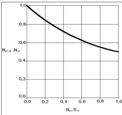
L'influenza della deformabilità a taglio sul carico ultimo (carico critico) risulta spesso trascurabile nel caso di profilati a parete piena ( $N_{cr}/S_V \rightarrow 0$ ) mentre è significativo nel caso di aste composte ( $N_{cr}/S_V \rightarrow 1$ ).
