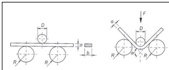
La provetta usualmente di forma rettangolare viene assoggettata a flessione continua senza inversione della forza. Al termine della prova il campione viene esaminato sulla faccia esterna della parte piegata per rilevare l'eventuale presenza di screpolature o fenditure. Le deformazioni ottenute confermano in genere i valori dell'allungamento a rottura della prova di trazione.
