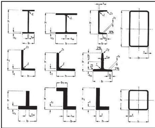
Sezioni caratteristiche di **elementi saldati**.
