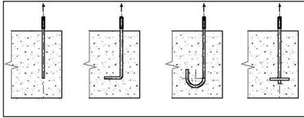
Particolari di sistemi di ancoraggio di **tirafondi** per il trasferimento in fondazione di forze di trazione di limitata entità, attraverso:
