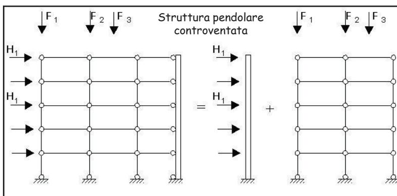
La struttura risulta isostatica:
