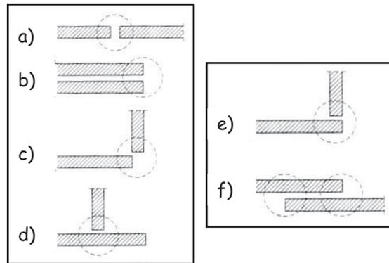
in funzione della lavorazione delle parti a contatto, limitatamente ai giunti testa a testa:
