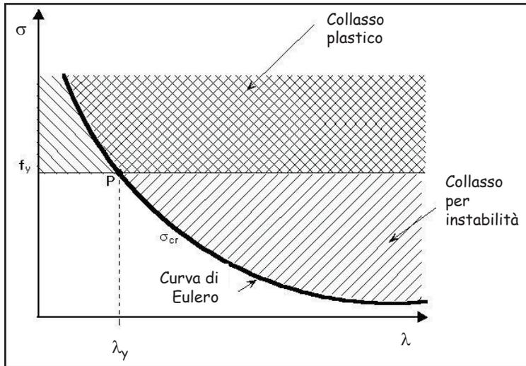
Il punto P di intersezione tra le due curve (retta  $\sigma=f_y$  ed iperbole di Eulero) definisce il **limite di snellezza  $\lambda_y$  al limite di proporzionalità** superato il quale ( $\lambda > \lambda_y$ ) si ha collasso per instabilità (snellezza a cui corrisponde un carico critico euleriano  $\sigma_{cr}$  pari alla resistenza a compressione semplice del materiale  $f_y$ ).
