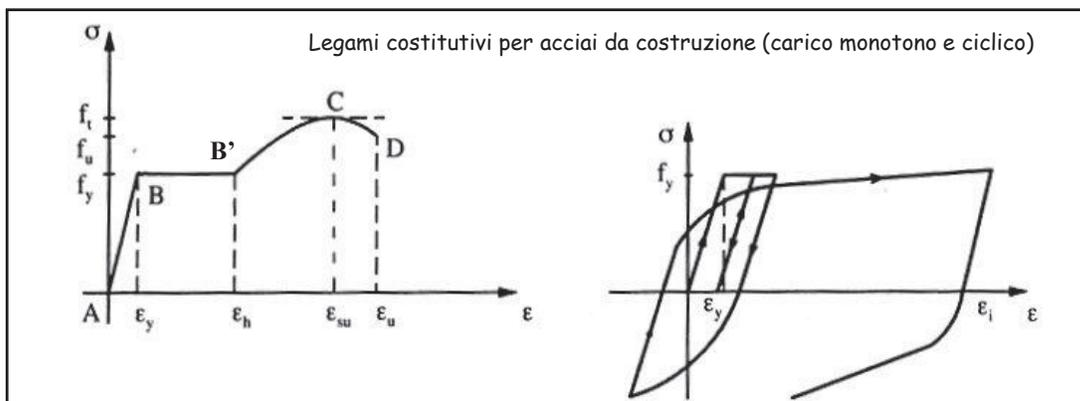
▪ **campo elastico** (tratto A-B): le tensioni sono proporzionali alle deformazioni con costante di proporzionalità pari al **modulo elastico del materiale (E)**; in caso di scarico si verifica il recupero totale delle deformazioni.
