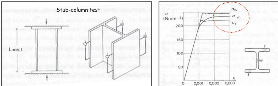
Il diagramma  $\sigma$ - $\epsilon$  ottenuto dalla prova di compressione globale (stub-column test) presenta in genere una tensione limite di proporzionalità più bassa rispetto a quella corrispondente alla prova di trazione su singoli provini. Ciò è dovuto alla presenza di imperfezioni strutturali che rivestono un ruolo degradante sulla resistenza dei profilati.
