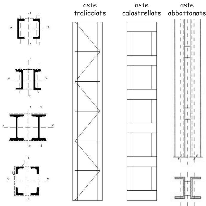
A seconda del tipo di collegamento è possibile classificare le aste composte in:
