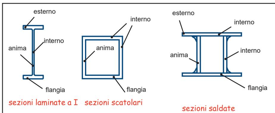
Quando alcuni elementi componenti sono **relativamente sottili possono instabilizzare localmente**, limitando la capacità portante e la resistenza flessionale del profilato. Per evitare tale fenomeno è necessario impiegare profilati le cui parti elementari siano caratterizzate da un rapporto  $b/t$  (larghezza/spessore) sufficientemente basso.
