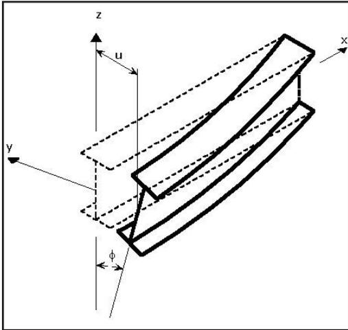
Riferendosi al dimensionamento di strutture a uso civile e industriale, nella maggior parte dei casi la soletta in c.a. o la copertura (in lamiera grecata), che è sostenuta dalla trave può contrastare efficacemente sia gli spostamenti trasversali dell'ala superiore sia la rotazione della sezione della trave, fungendo da vincolo continuo effettivo nei confronti dell'instabilità laterale.
