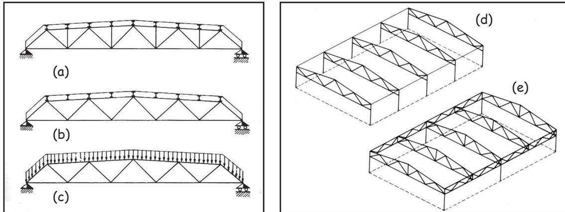
Nel caso di trave principale reticolare, la briglia superiore risulta per lo più compressa se gli arcarecci cadono sui nodi (a), pressoinflessa se essi sono disposti fuori nodo (b) o se l'elemento coprente trasmette direttamente il carico alla trave reticolare (c).
