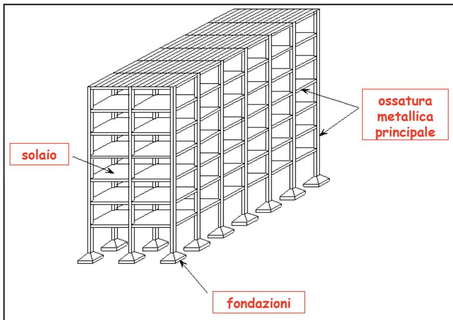
In molti casi le strutture multipiano in acciaio possono risultare più vantaggiose rispetto a quelle in cemento armato, in particolare questo si verifica:
