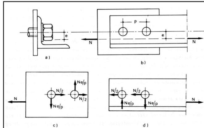
Se gli assi baricentrici delle aste di ciascun nodo convergono in un punto, la piastra di collegamento e le aste sono sollecitate da solo sforzo assiale  $N$  mentre il collegamento bullonato è sollecitato oltre che da  $N$  anche da un **momento parassita** proporzionale alla distanza tra l'asse di truschino e l'asse baricentrico dell'asta.
