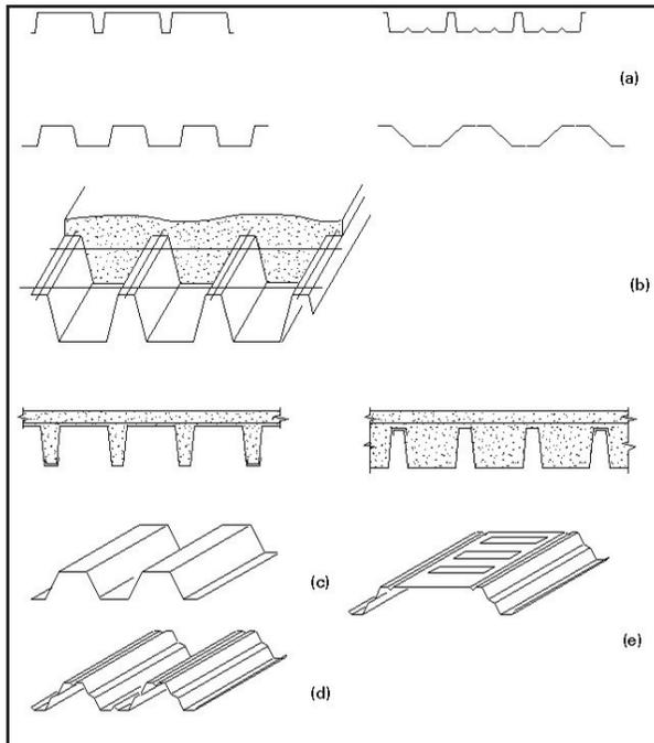
Gli elementi in lamiera grecata hanno spessore compreso tra 0.6 e 1.5 mm ed altezze variabili tra 40 e 90 mm; il collegamento con le travi può avvenire attraverso viti autofilettanti o chiodi sparati.
