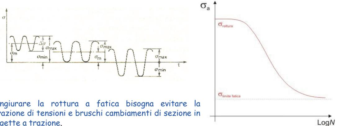
Per scongiurare la rottura a fatica bisogna evitare la concentrazione di tensioni e bruschi cambiamenti di sezione in zona soggette a trazione.
