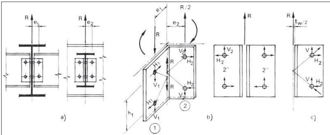
I collegamenti bullonati nei piani 1 e 2 devono essere verificati per un sistema di forze con componente verticale pari alla reazione della trave e componente orizzontale proporzionale ai momenti flettenti che si generano per effetto delle due eccentricità.
