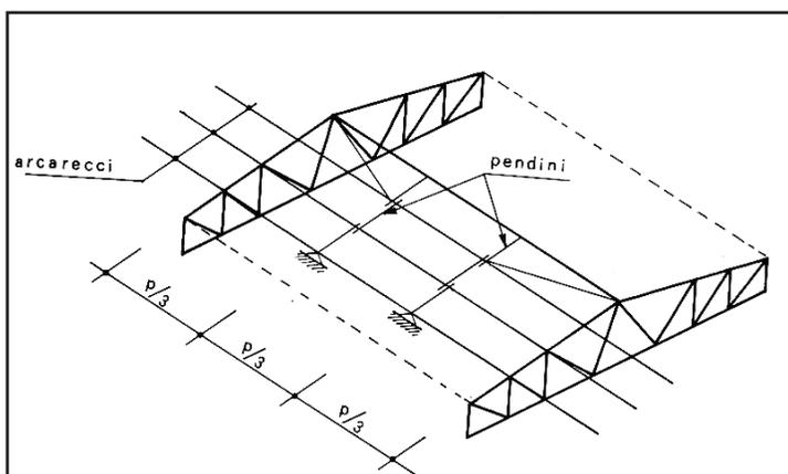
Nel piano di falda l'arcareccio può essere schematizzato come una **trave su più appoggi**. Nel piano normale alla falda (piano verticale) l'interasse fra le travi non permette in genere di superare con un unico elemento più di due campi, **la lunghezza commerciale dei profilati non supera, infatti, i 12 m.**
