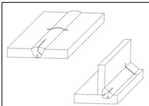
Le cricche sono microlesioni che interrompono la continuità della saldatura.
