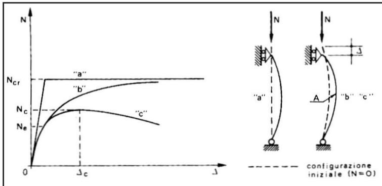
L'acciaio non è un materiale indefinitamente elastico. Il comportamento di un'asta reale può essere caratterizzato da un valore del carico ultimo sensibilmente inferiore al valore critico euleriano. Una volta raggiunto il carico  $N_e$  corrispondente al raggiungimento del limite elastico nella fibra maggiormente sollecitata l'asta evolve in campo elasto-plastico (curva c).
