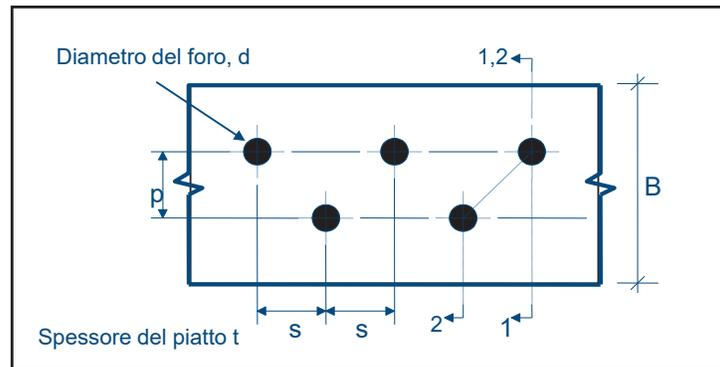
Nel caso di collegamenti non simmetrici: sezioni a L o a T collegati solo da un'ala, il calcolo di  $A_{net}$  va effettuato con le formule riportate nell'EC3.
