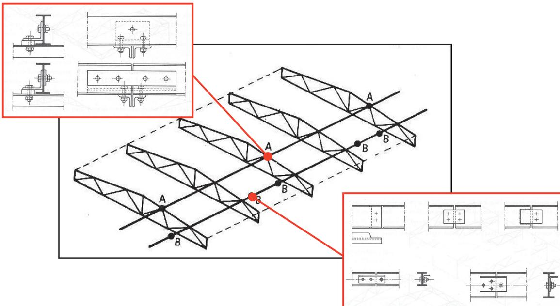
Per semplificare le giunzioni fra i vari elementi dello stesso arcareccio (pt.i A e B) si è soliti utilizzare un collegamento che interessi la sola anima del profilato.
