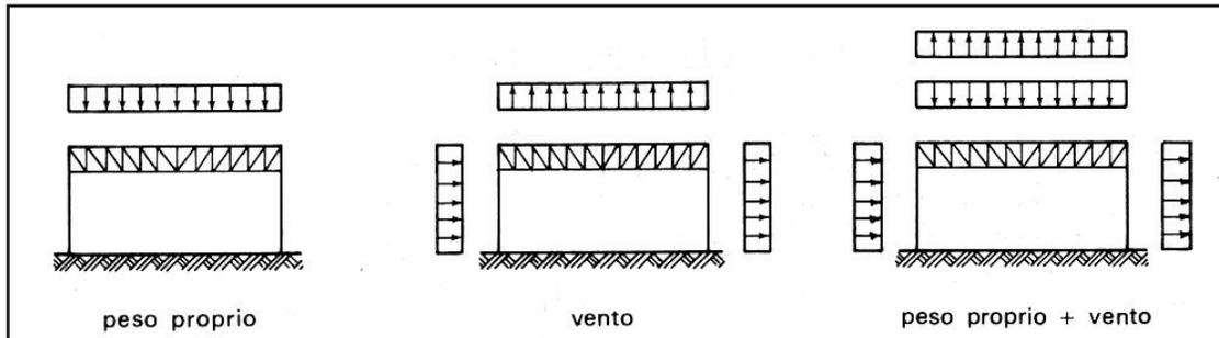
Il carico da vento produce una depressione in copertura che può essere rappresentata da una pressione normale diretta nel verso opposto all'azione gravitazionale e di entità che spesso risulta superiore al carico permanente in copertura. Nelle strutture metalliche di copertura si può creare una inversione nel segno delle azioni interne nelle membrature componenti. Aste di elevata snellezza, dimensionare come tese, possono collassare se sollecitate da un'azione assiale anche se di modesta entità.
