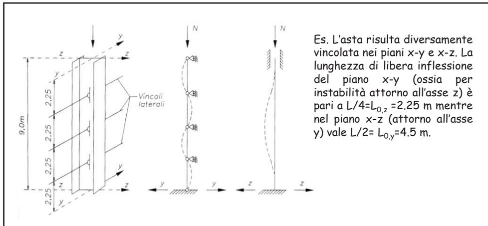
Determinazione delle lunghezze libere di inflessione in funzione dello schema statico.
