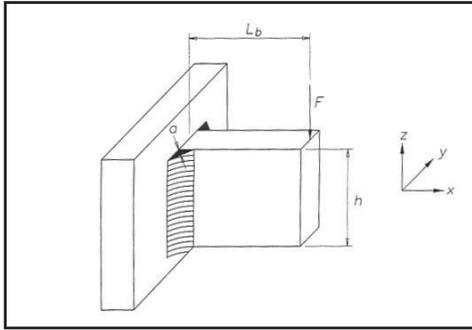
Cordoni frontali longitudinali: la sezione resistente giace nel piano verticale (y-z) ed è costituita da due sezioni rettangolari, corrispondenti alla sezione di gola di ogni cordone di altezza a e lunghezza L.
