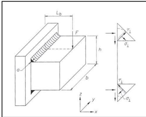
Cordoni trasversali: la sezione resistente giace nel piano verticale (y-z) ed è costituita da due sezioni rettangolari orizzontali, corrispondenti alla sezione di gola di ogni cordone di altezza a e lunghezza b.
