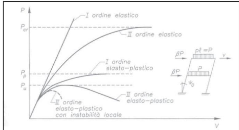
Nel caso di strutture controventate esiste una ripartizione dei compiti tra elementi strutturali che riprendono i carichi verticali e sistemi strutturali a cui è affidato il compito di resistere alle azioni orizzontali. Le travi orizzontali risultano inflesse nel piano verticale (sotto l'azione dei carichi verticali), le colonne semplicemente compresse e le giunzioni a cerniera fra travi e colonne devono assorbire solo le azioni taglianti.
