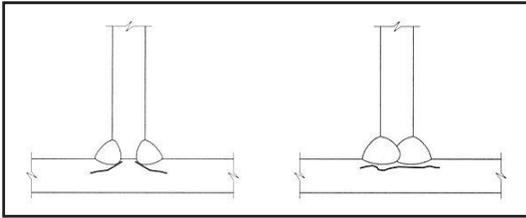
Gli strappi lamellari corrispondono a cricche dovute ad una sollecitazione di trazione ortogonale al piano di laminazione del materiale base (sono generate dalle tensioni di ritiro successive al raffreddamento e dal notevole spessore del materiale base).
