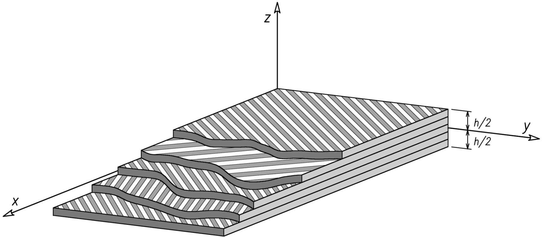
*Convenzione per la quotatura delle interfacce delle lamine*
