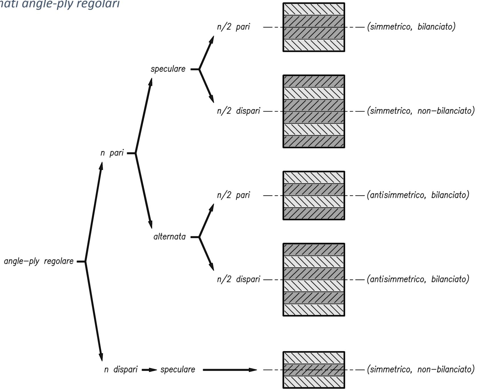
In presenza di un laminato *simmetrico* rispetto al piano medio e con numero *pari* di lamine si indica solo metà sequenza, aggiungendo alla notazione il pedice “s”; ad esempio:
