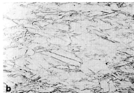
Fig. 6.1.6. Microstruttura della lega CoNiCrMo: a) condizioni di soluzione solida omogenea, grani austenitici completamente ricristallizzati (500x), b) dopo forgiatura a caldo (500x).
