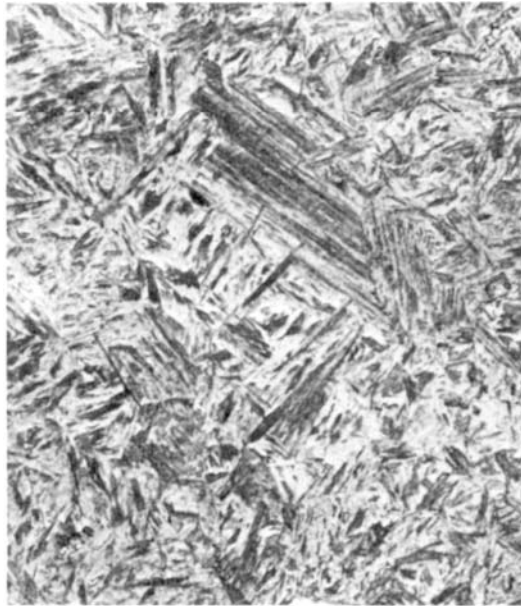
Struttura martensitica (Microscopio ottico x600)
