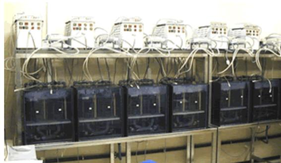
Al termine dei sei mesi di prova sei sistemi sono stati fermati, provati in laboratorio, smontati e analizzati per rilevare danni o segni di usura. Tutti questi sistemi erano in perfette condizioni di funzionamento, avevano caratteristiche rientranti nelle specifiche costruttive e non mostravano alcun segno di usura anomala o danneggiamento. I restanti sei sistemi sono stati mantenuti in
