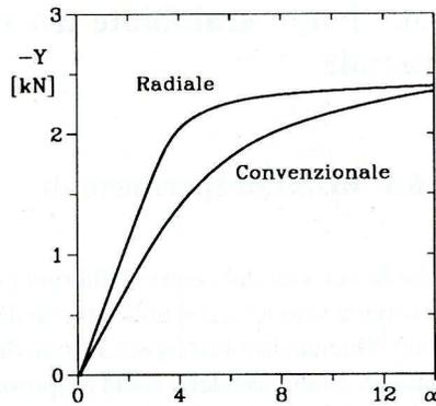
Figura 1-38. Andamenti schematici della forza  $Y$  con l'angolo di deriva  $\alpha$  per un pneumatico radiale e per uno convenzionale.
