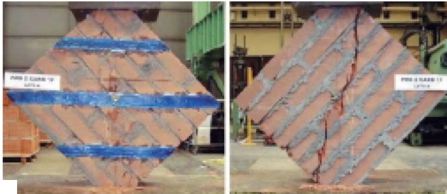
9. Rottura di un pannello rinforzato diagonalmente su una faccia con CFRP.
