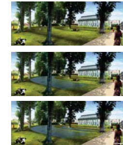
Pérouse reconverte en bassin sec de rétention
