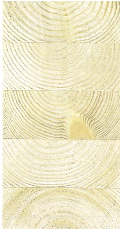
Figura 3.8 - Corretta disposizione degli anelli di accrescimento
