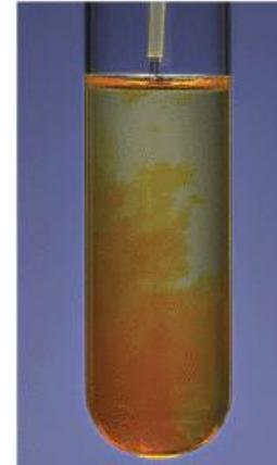
(c)  $\text{FeCl}_3$  ed  $\text{NaOH}$  formano  $\text{Fe}(\text{OH})_3$  rosso insolubile ed  $\text{NaCl}$  solubile.
