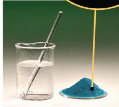
All'acqua viene aggiunto del cloruro di rame. Le interazioni tra l'acqua e gli ioni  $\text{Cu}^{2+}$  e  $\text{Cl}^-$  permettono la solubilizzazione del solido.
