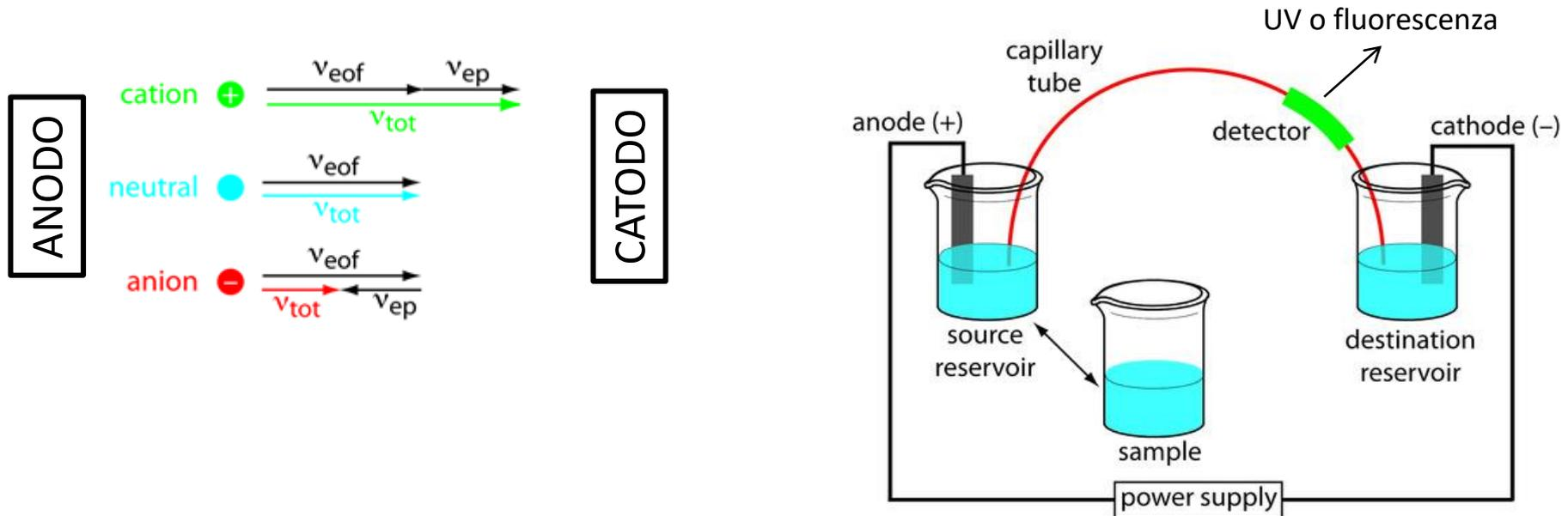
**Esempio di applicazione:** separazione di frammenti di DNA
