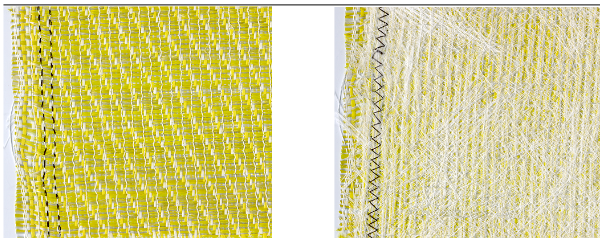
Figura 2.11 — Lato stuoia e lato mat di un rinforzo tipo Aramat
