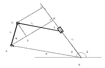
Il vettore di "telaio fittizio" è rappresentato dal segmento BA. Si procede tracciando la retta passante per A e perpendicolare all'asse di traslazione. Successivamente si traccia un'altra retta, passante per G e perpendicolare alla precedente AH.
