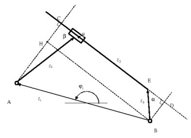
$z_t$  e  $\varphi_t$  si determinano come per la diade precedente, con l'avvertenza di osservare che il vettore  $z_t$  è orientato verso sinistra in alto
