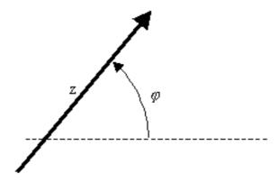
Ogni vettore è definito da due parametri: il modulo e la posizione angolare; l'angolo è considerato positivo quando la rotazione avviene in senso antiorario rispetto all'orizzontale (è semplicemente una convenzione che si adotterà d'ora in poi).
