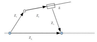
I dati geometri sono:  $z_1=0.1m$ ,  $z_3=0.17m$ ,  $z_4=0.4m$ ,  $\delta=84^\circ$ , mentre  $\varphi_1=60^\circ$  è il valore assegnato alla coordinata indipendente.
