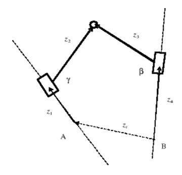
Notare che le incognite sono moduli di vettori. Non vi è alcun angolo incognito. Ciò permette di impostare una equazione di chiusura ottenento, a differenza delle altre diadi, una soluzione lineare del sistema.
