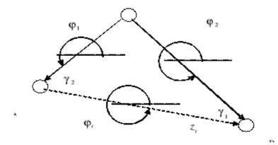
Se sono noti solamente le coordinate dei punti A e B, si calcola modulo e posizione angolare del vettore che congiunge le coppie rotoidali estreme
