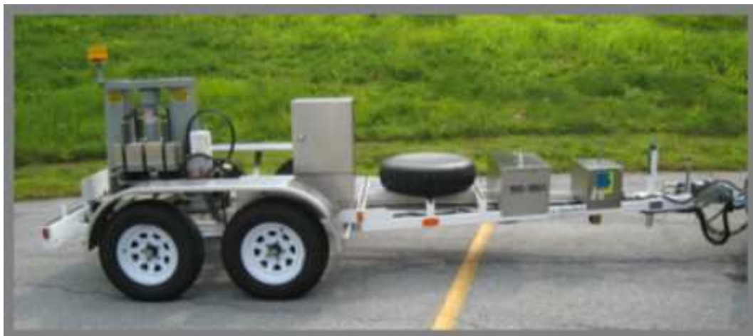
Figura 3.40 Deflettometro a massa battente per usi stradali (FWD)
