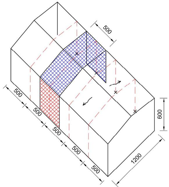
Velocità di riferimento  $V_r$ :Zona Trieste  $\Rightarrow$  Zona 8 $V_{b,0} = 30 \text{ m/s}$  -  $a_0 = 1500 \text{ m}$  -  $k_s = 0.50$  $a_s \sim 0 \text{ m s.l.m.m.}$   $\Rightarrow a_s < a_0 \Rightarrow c_a = 1$  $\Rightarrow v_b = v_{b,0} c_a = 30 \times 1 = 30 \text{ m/s}$  $T_R = 50 \text{ anni}$   $\Rightarrow v_r = v_b c_r(T_R) \Rightarrow c_r(T_R=50) = 1$  $v_r = v_b c_r = 30 \times 1 =$  $v_r = 30 \text{ m/s} = 108 \text{ km/h}$
