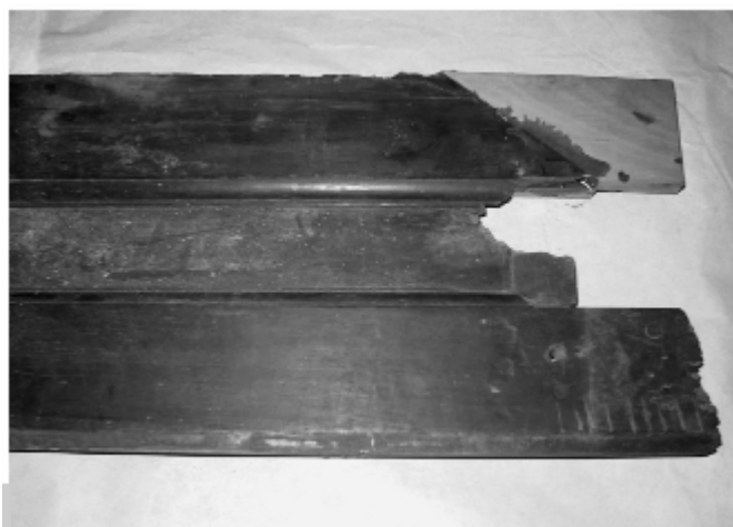
Figura 3 • Integrazione di un'anta di armadio. La parte irrecuperabile è stata rimossa per essere sostituita con più tasselli ad incastro. Il primo elemento è incollato nella parte terminale di un montante. (LAP)
