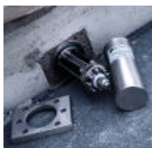
Fig. 30 • Assisi, Basilica di San Francesco, posa in opera dei dispositivi SMAD.
