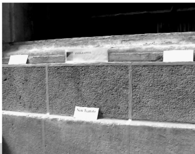
Figura 5 • Provini per l'applicazione di due prodotti protettivi su "pietra di Finale". I prodotti protettivi, ora asciutti, mantengono, ognuno con proprie caratteristiche, le qualità cromatiche della superficie lapidea non trattata. (SAL)
