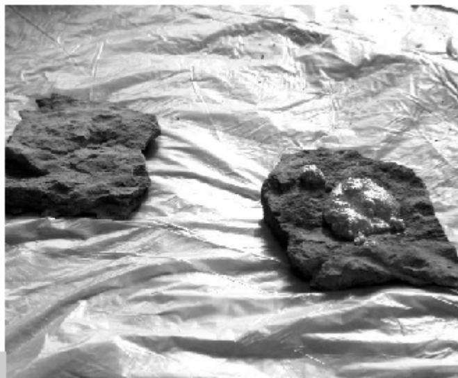
Figura 1 • Operazione di riadesione mediante incollaggio. Consiste nel ricollegare tra loro, o con il manufatto di cui sono parte, frammenti di pietra parzialmente o totalmente distaccati mediante l'applicazione di collanti. (ZAM)
