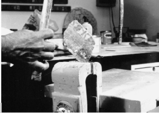
Figura 3 • Taglio di un elemento lapideo secondo la tecnica tradizionale del “commesso”. (OPD)
