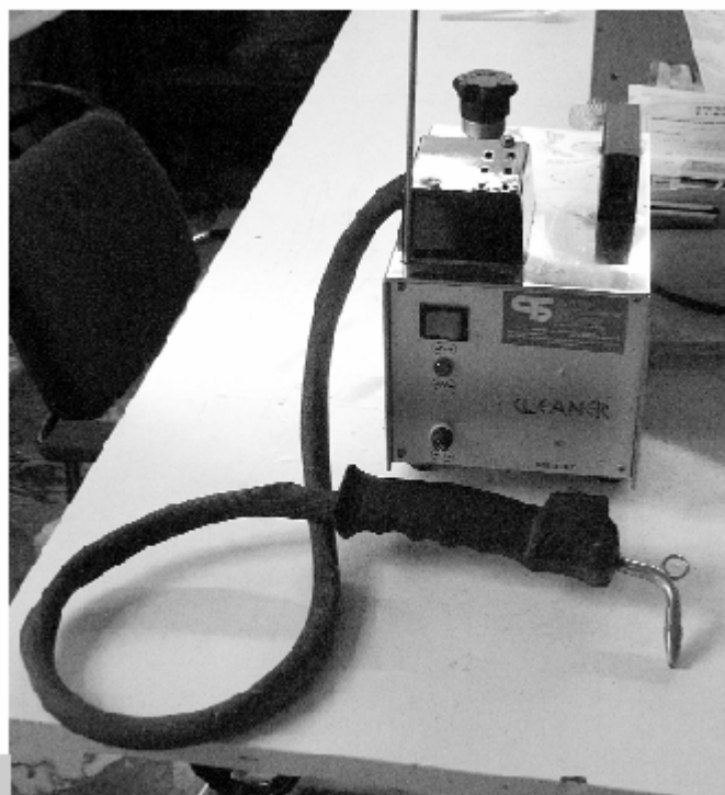
Figura 1 • Apparecchiatura per la pulitura con spray 1 d'acqua a getto di vapore. (OPD)
