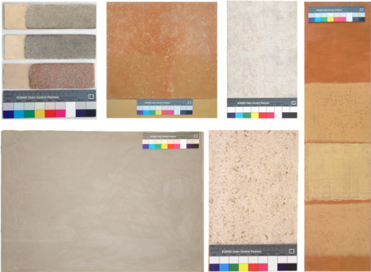
Figura 5 • “Materiali virtuali”: campioni di malta, di intonaco e di velature di diversa composizione e finitura superficiale utilizzabili per la simulazione delle integrazioni delle lacune, delle risarciture della malta di allettamento, della stuccatura di lesioni, rotture, mancanze ecc. (DEP)
