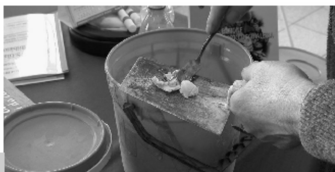
Figura 3 • Preparazione della gomma siliconica per la stuccatura dei bordi di frattura. (ZAM)
