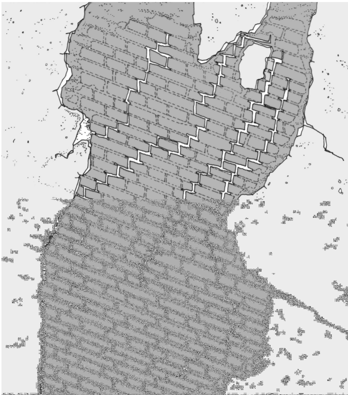
Figura 1 • In alcuni casi, la muratura da integrare non è ancora caduta, ma è conservata in situ , anche se in condizioni precarie tali da non poter essere riparata o consolidata e va completamente rimossa e sostituita. (CAF)
