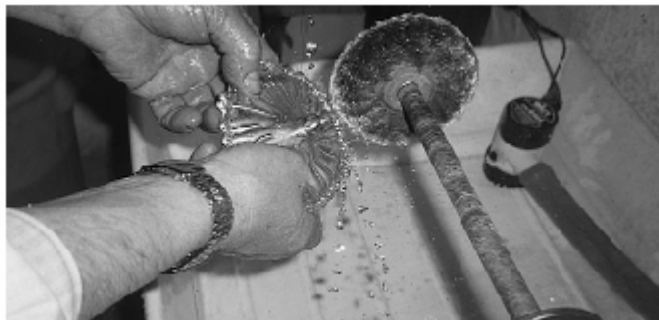
Figura 4 • Dopo il decapaggio, in una soluzione debolmente corrosiva per eliminare ossidi o scorie superficiali, il pezzo è pulito con la spazzola rotante di una pulimentatrice (v. PLT 23) sotto un getto d'acqua continuo.
