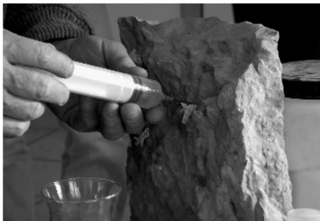
Figura 6 • L'incollaggio in profondità è eseguito utilizzando siringhe, assicurandosi che il distacco sia riempito il più possibile e procedendo a una immediata pulitura in caso di fuoriuscita del prodotto. (ZAM)
