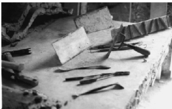
Figura 10 • Vari tipi di spatole e frattazzi.
